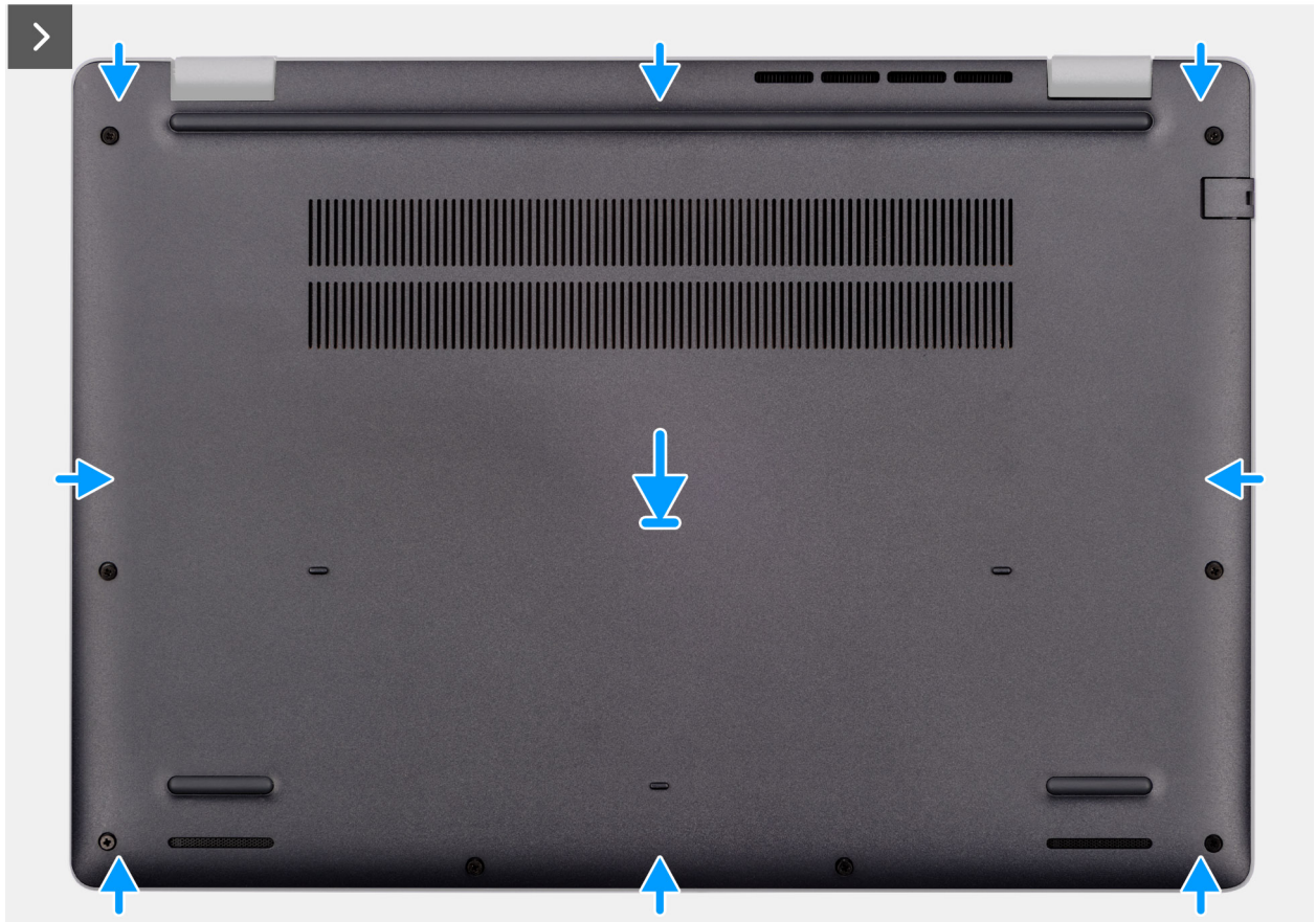
Figure 15. Installation du cache de fond
