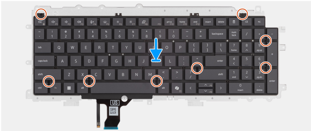
Figure 88. Installation de la plaque de support du clavier
