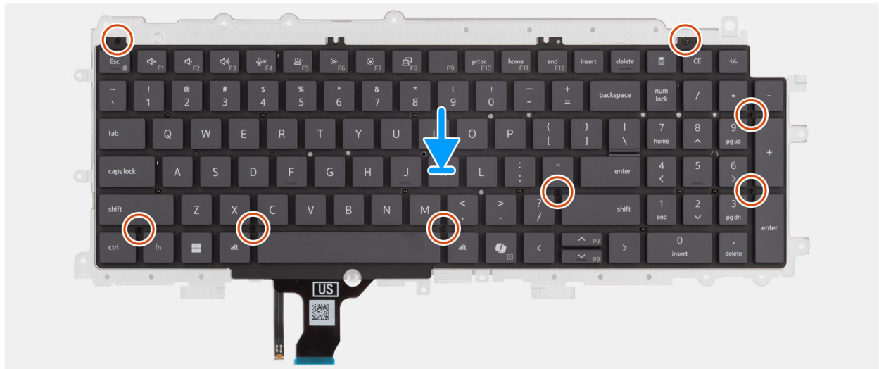
Afbeelding 88. De toetsenbordondersteuningsplaat installeren
