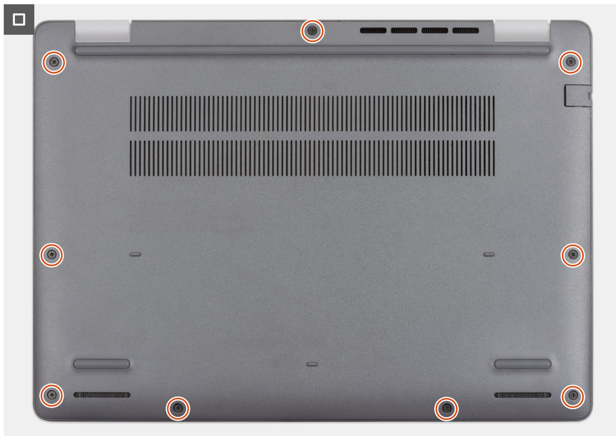
Figure 16. Installation du cache de fond
