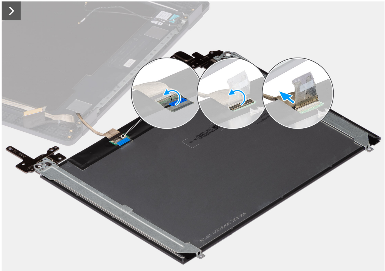
Figure 113. Retrait de l'assemblage du panneau d'écran
