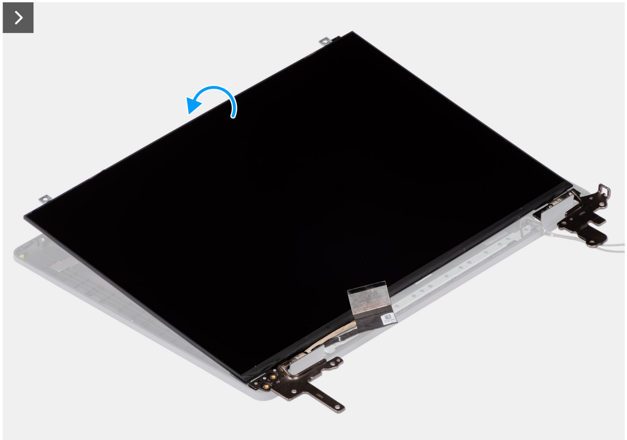
Figure 117. Installation de l'assemblage du panneau d'écran
