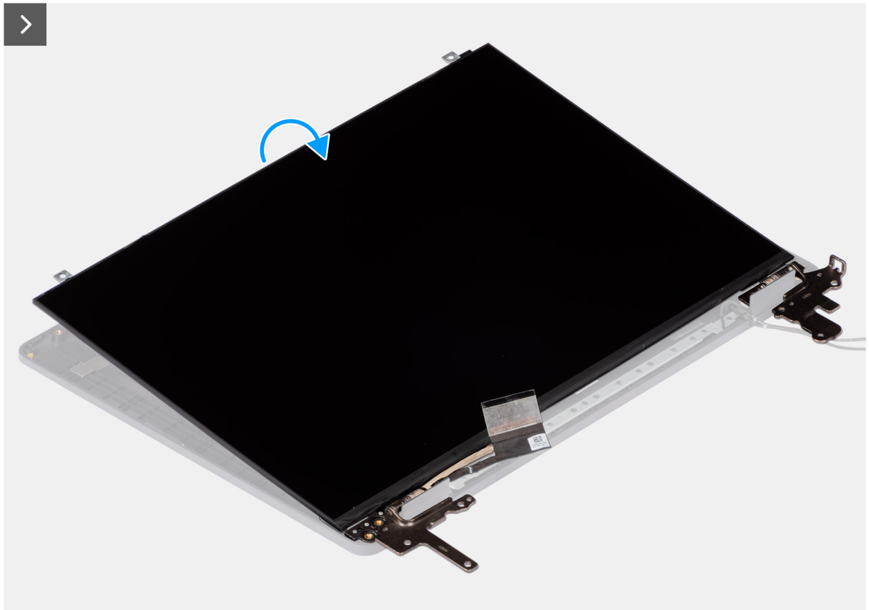
Figure 112. Retrait de l'assemblage du panneau d'écran
