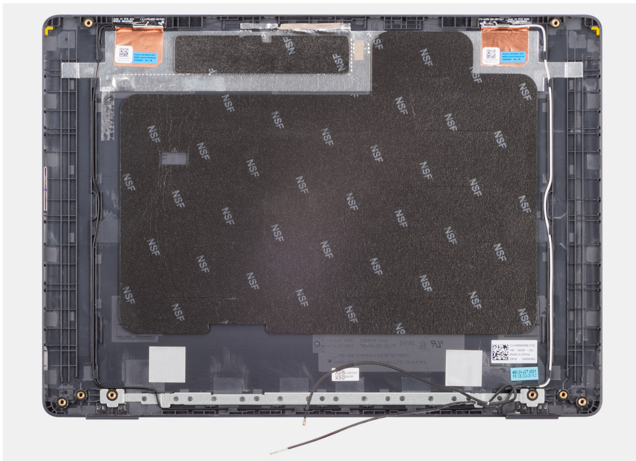
Figure 123. Retrait de l'assemblage du capot arrière de l'écran
