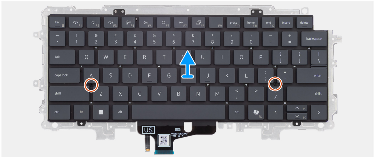
Figure 91. Retrait de la plaque de support du clavier
