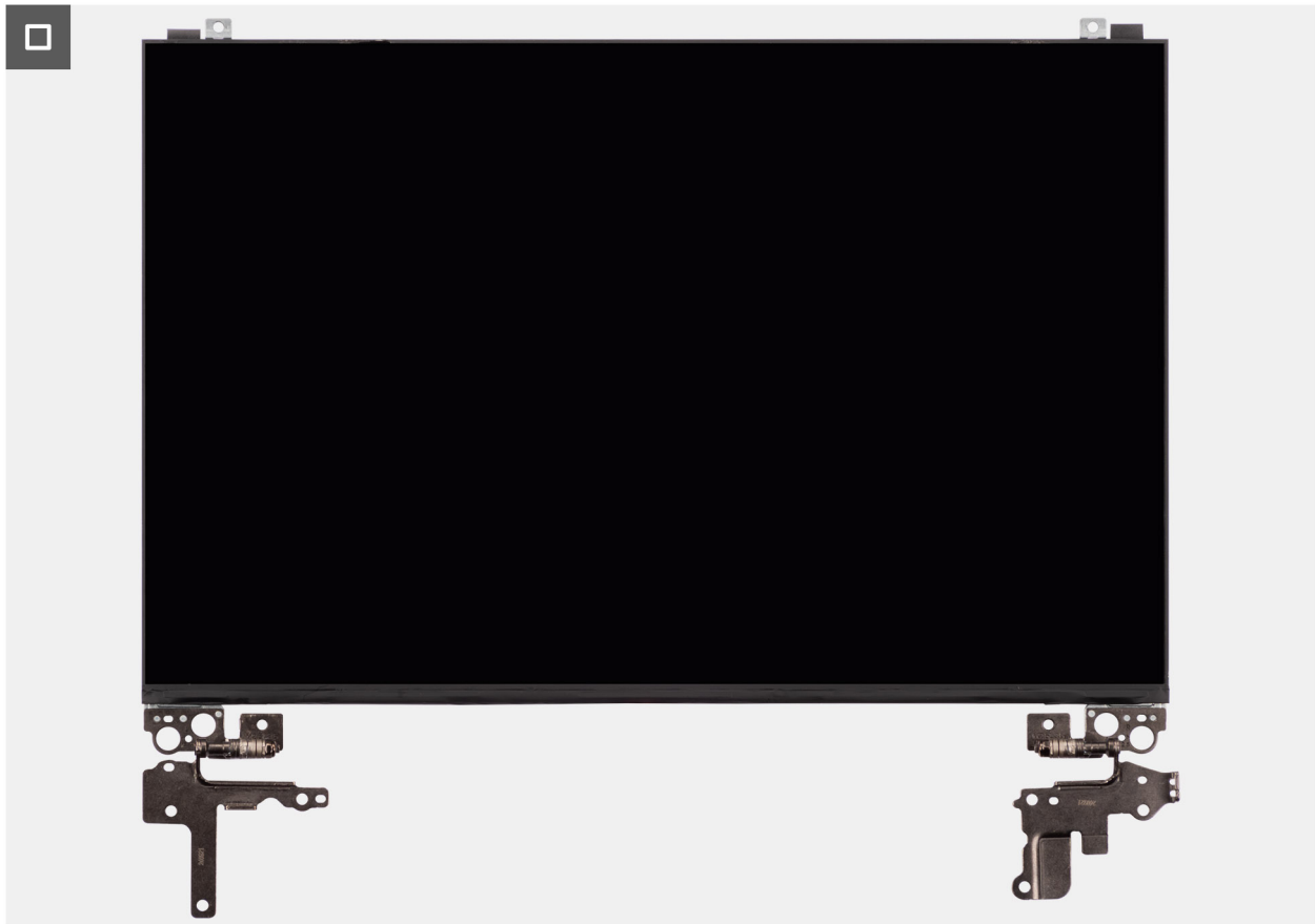
Figure 114. Retrait de l'assemblage du panneau d'écran
