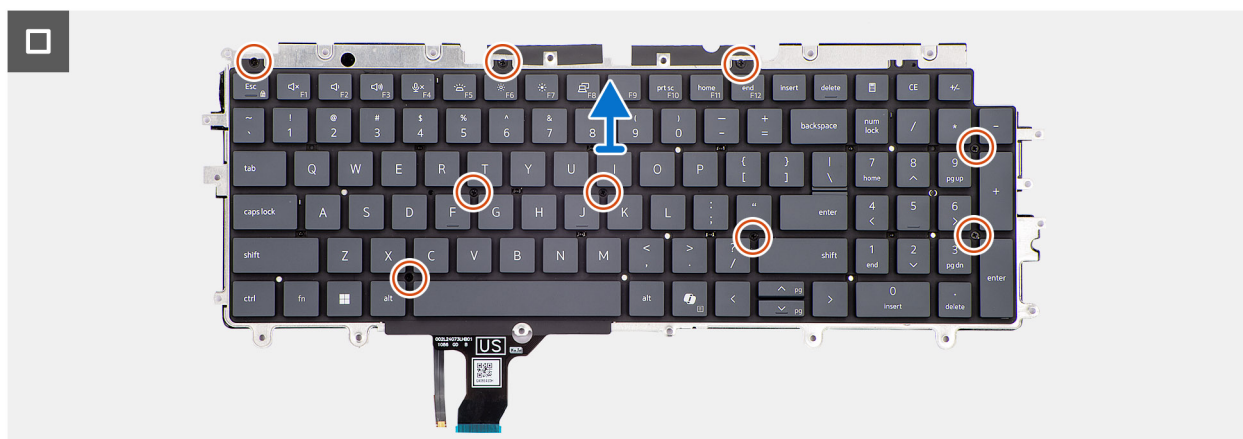
Figure 84. Retrait du clavier
