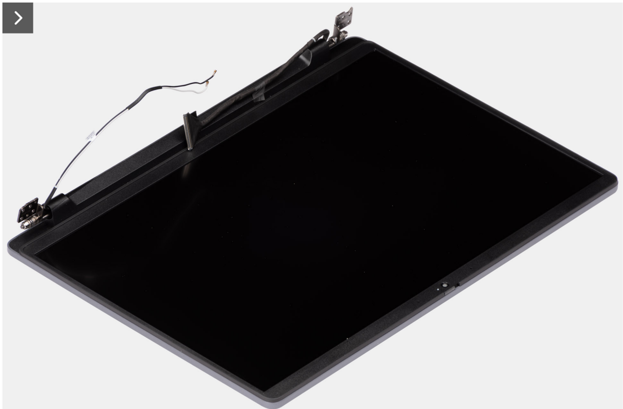
Figure 47. Installation de l'assemblage d'écran
