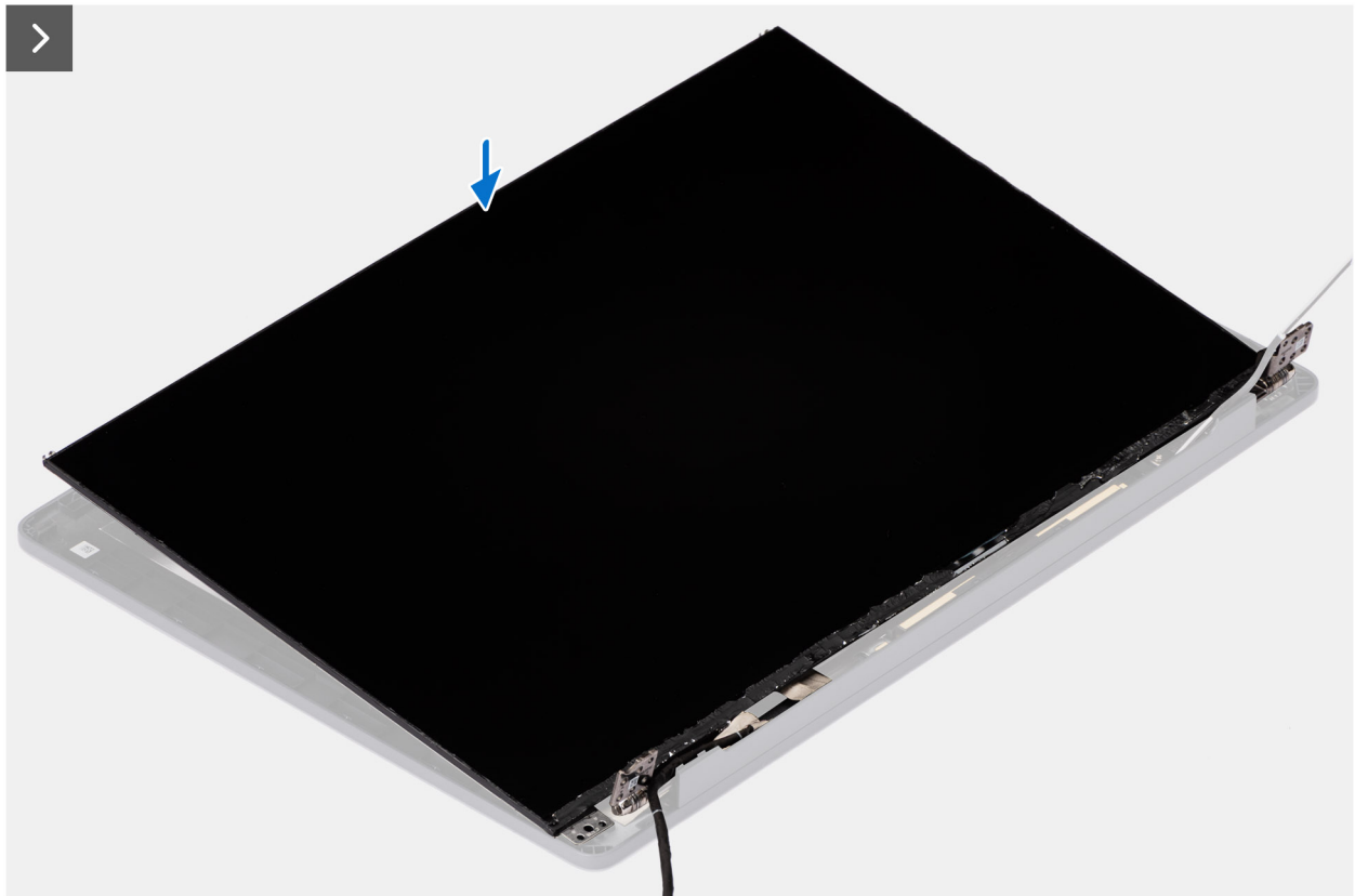
Figure 63. Installation du panneau d'écran
