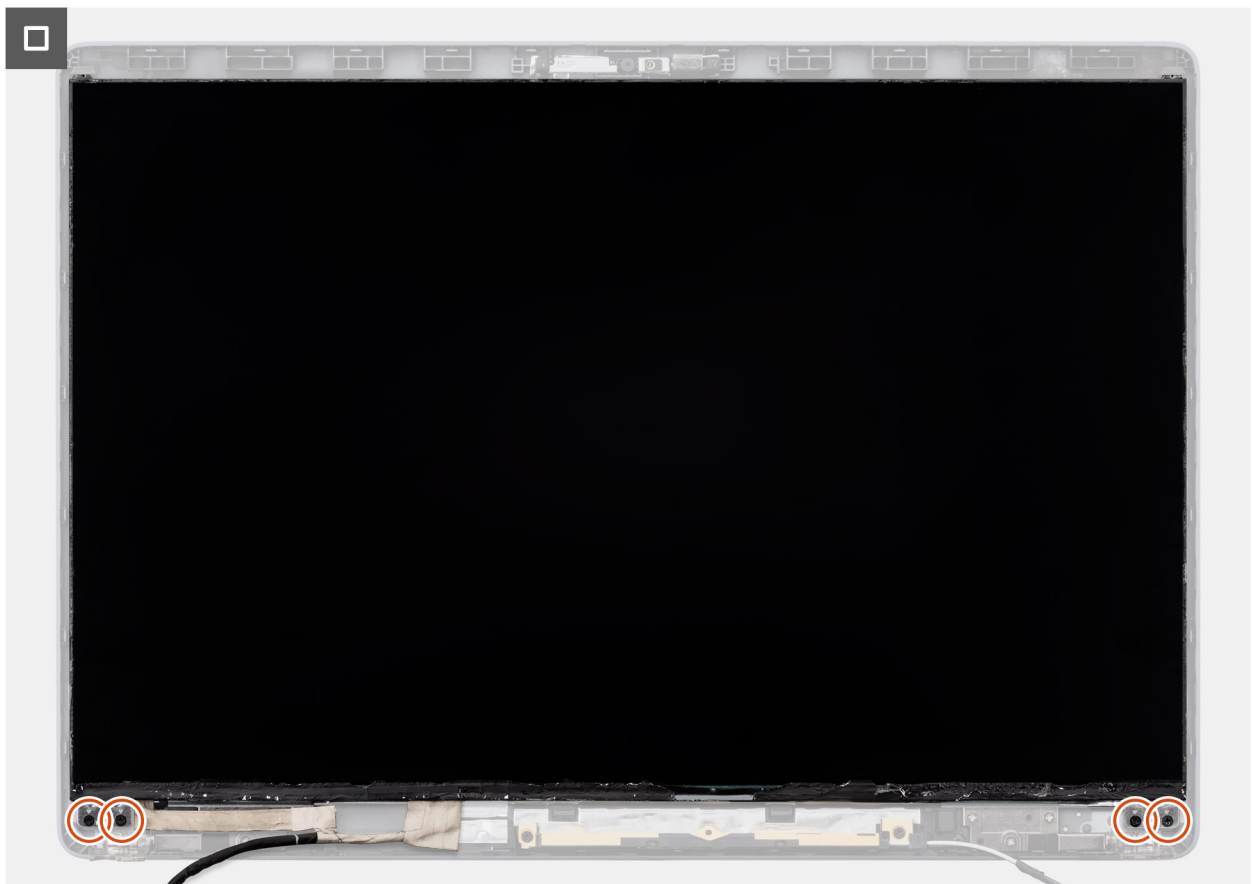
Figure 64. Installation du panneau d'écran
