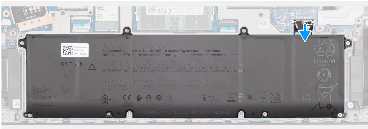
Figure 14. Retrait du câble de la batterie
