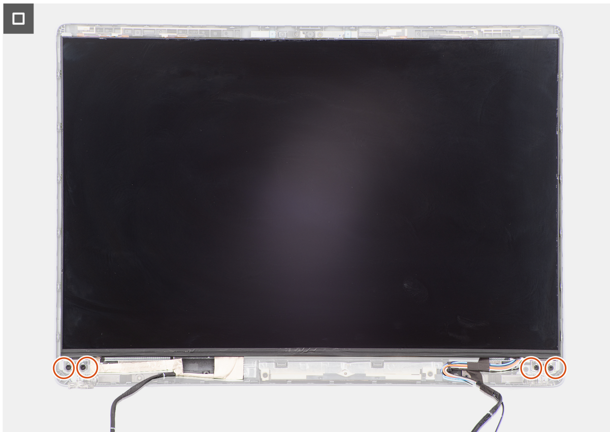
Figure 73. Installation du panneau d'écran
