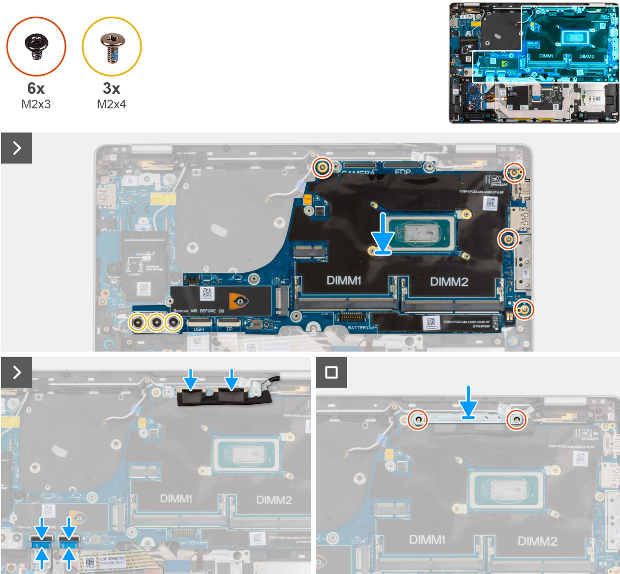
Ilustración 53. Instalación de la tarjeta madre
