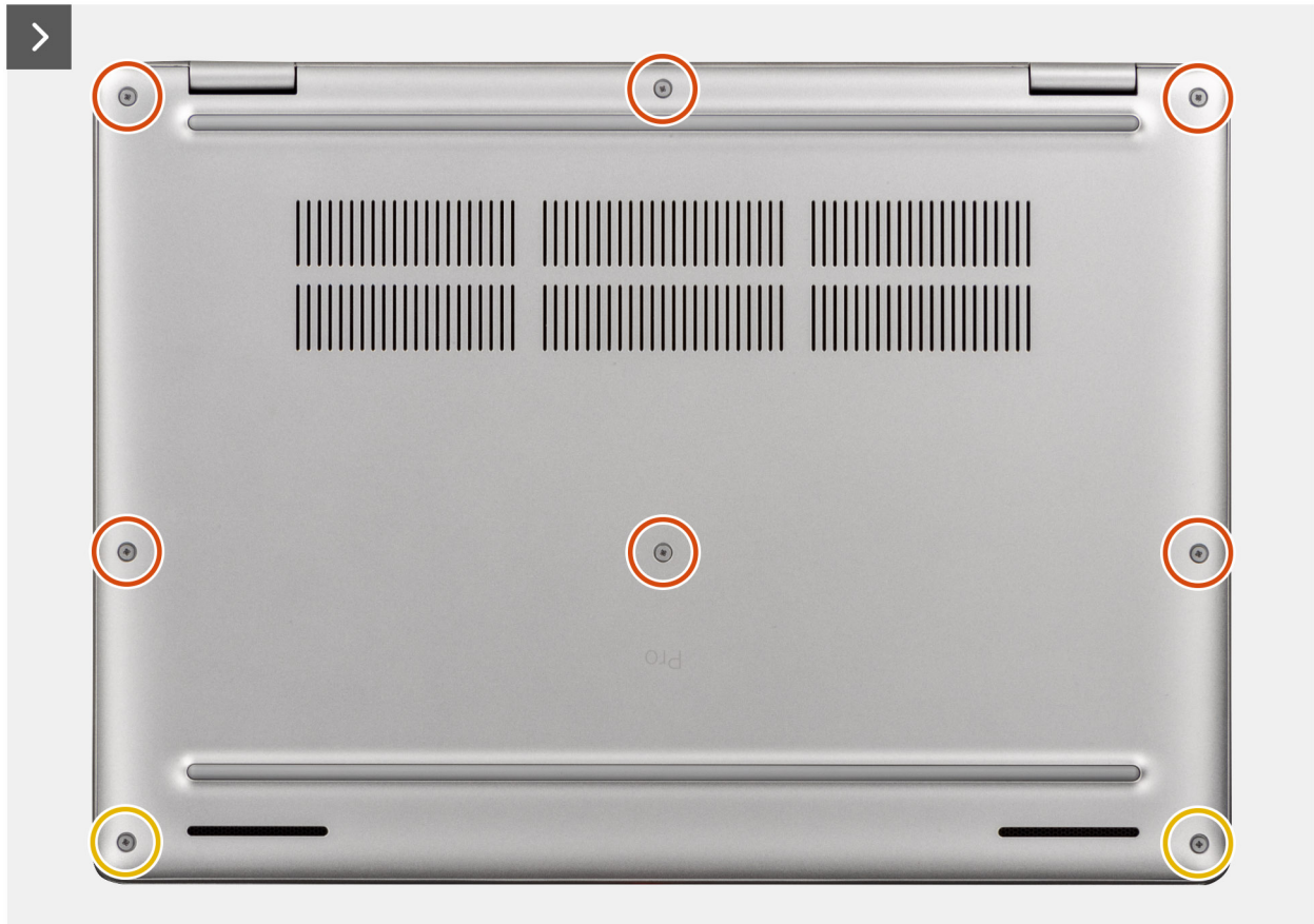
Ilustración 22. Extracción de la cubierta de la base
