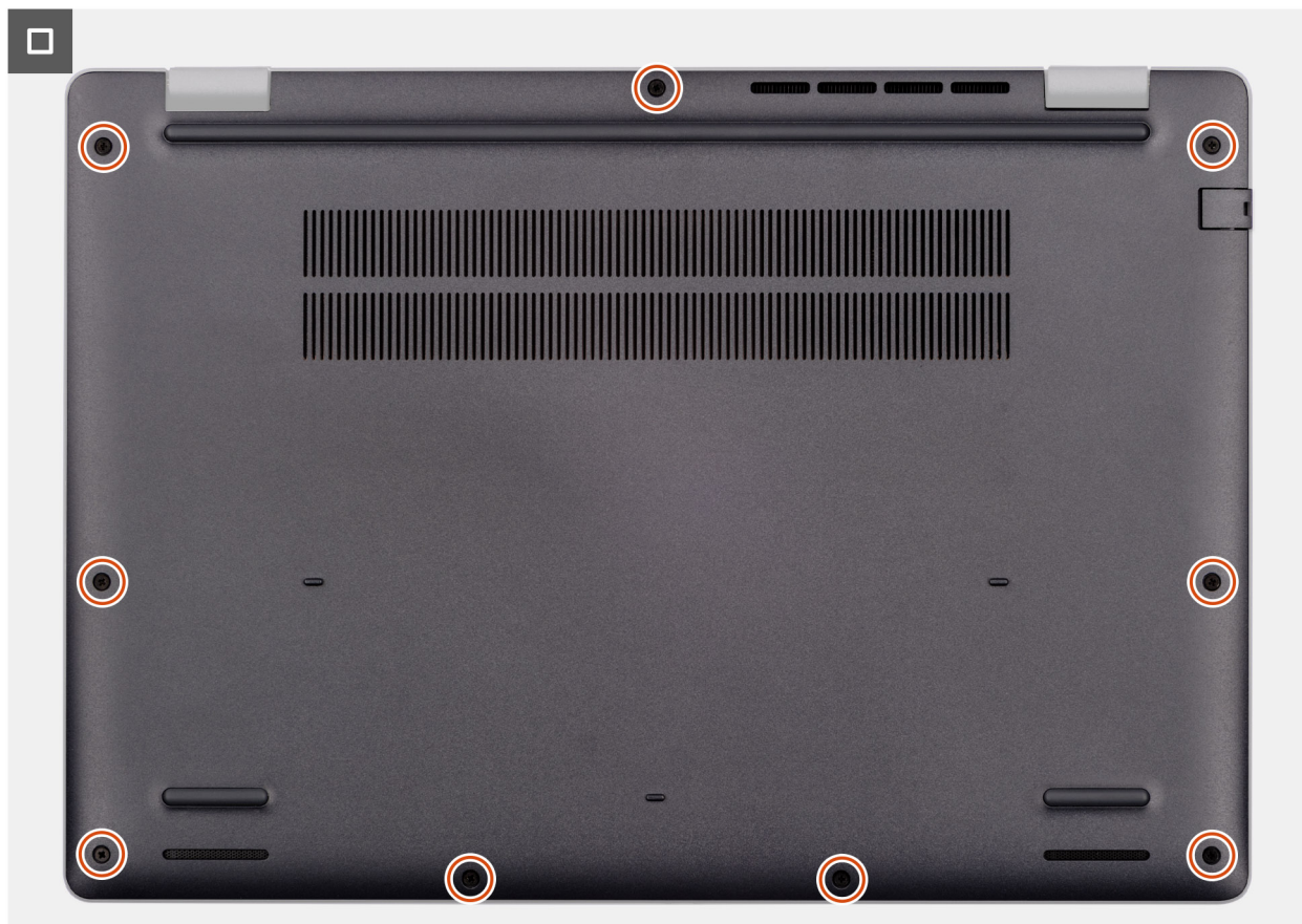
Figura 16. Installazione del coperchio della base
