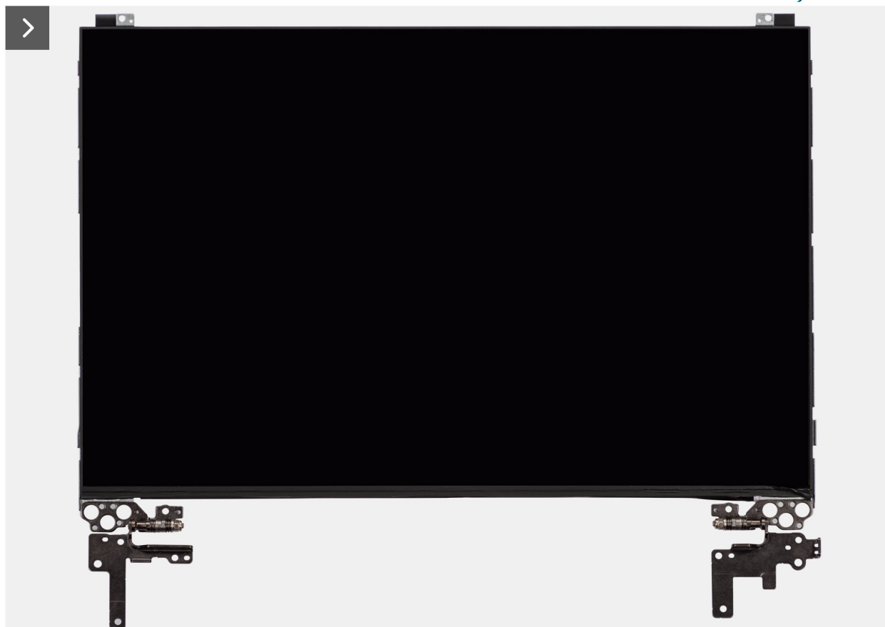
Figura 109. Installazione del gruppo del pannello del display
