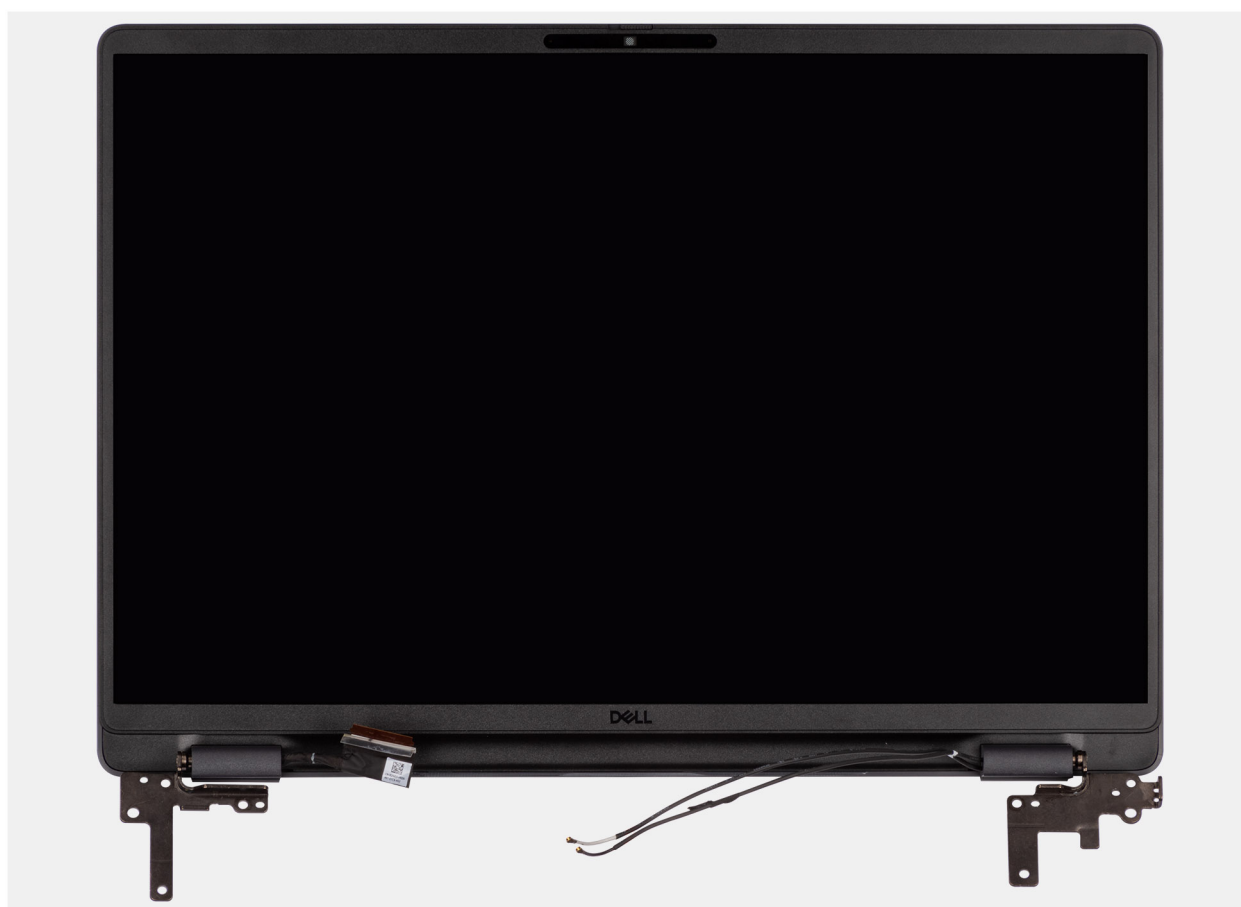
Figura 95. Rimozione del gruppo del display
