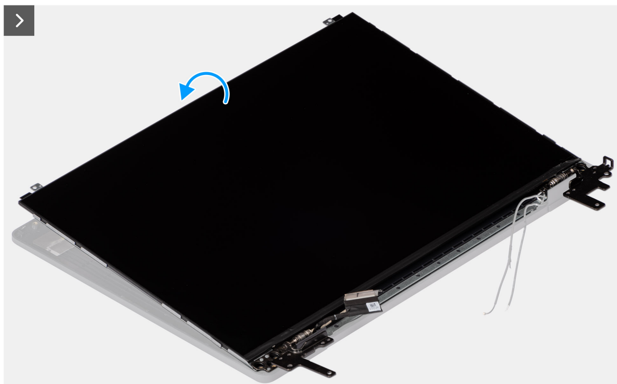
Figura 111. Installazione del gruppo del pannello del display
