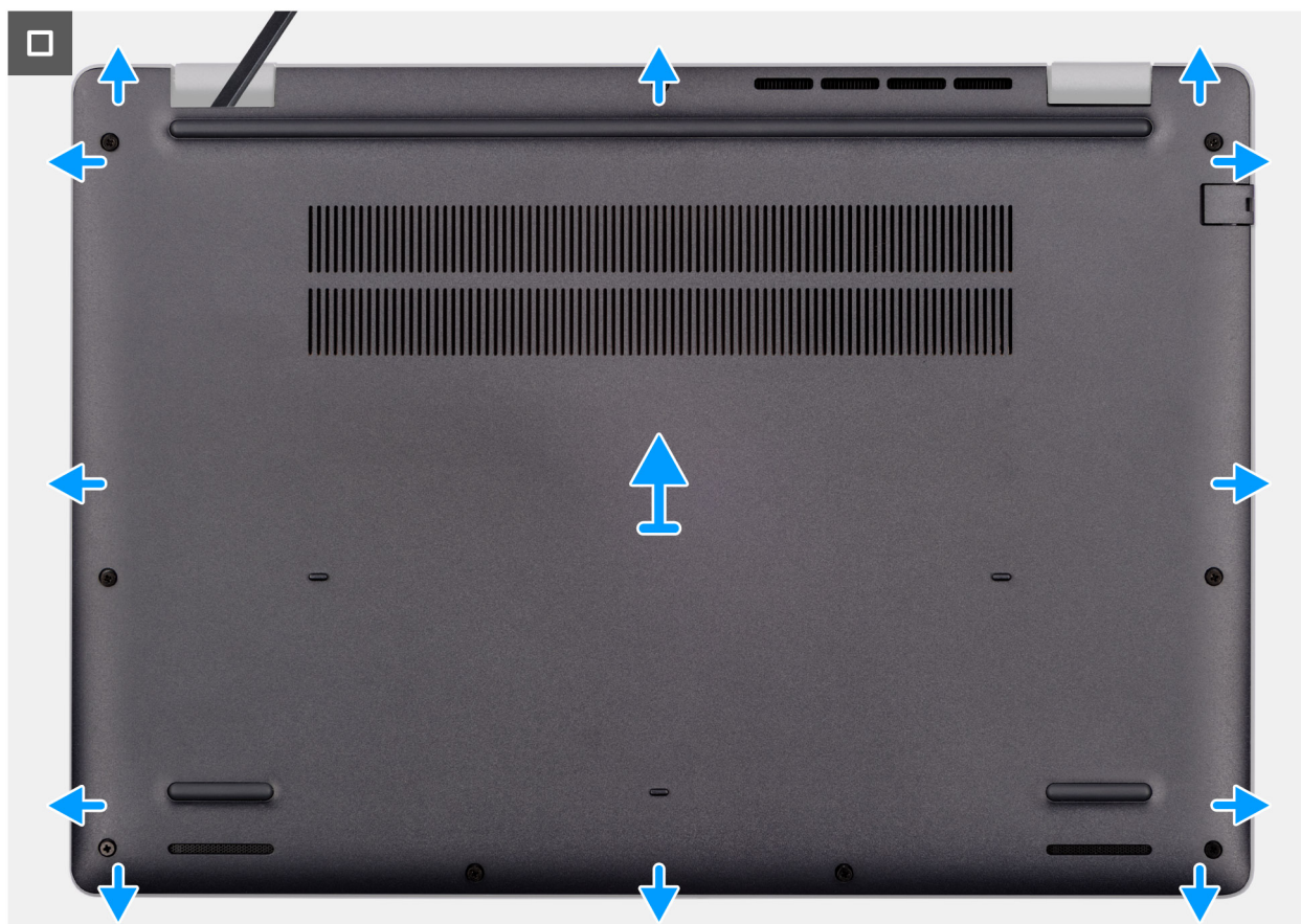
Figura 12. Rimozione del coperchio della base
