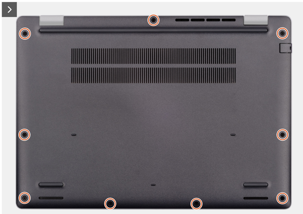
Figura 11. Rimozione del coperchio della base
