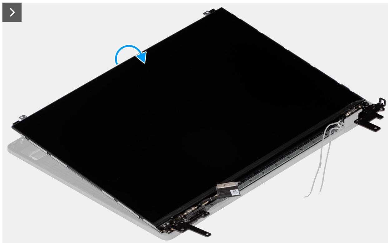
Figura 106. Rimozione del gruppo del pannello del display
