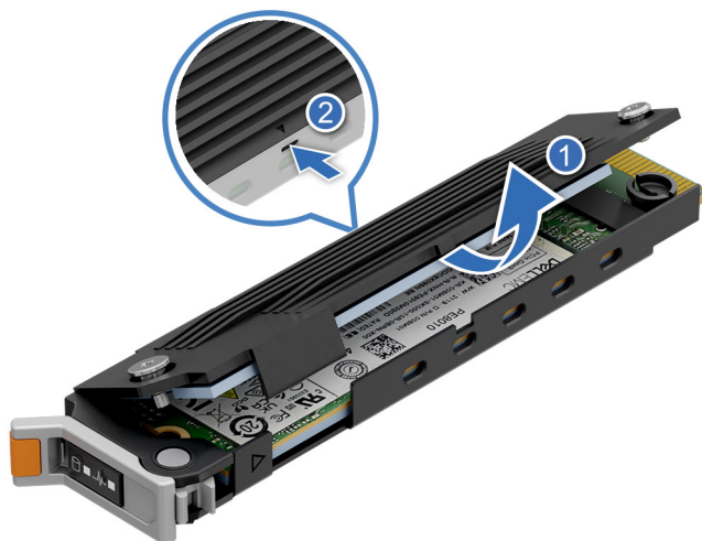
Ilustración 188. Extracción de la cubierta superior
