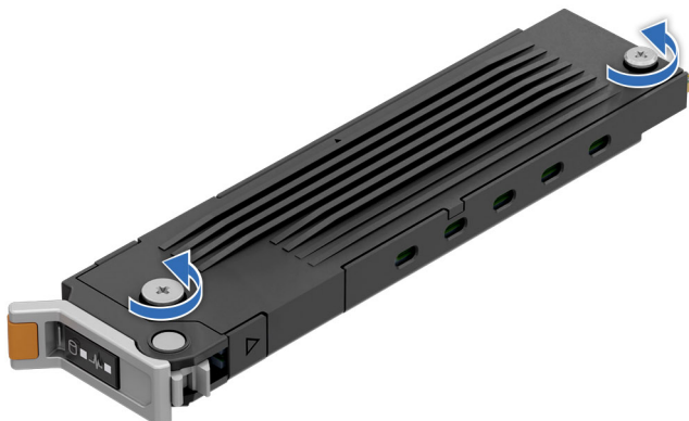
Ilustración 187. Cómo aflojar los tornillos cautivos de la cubierta superior
