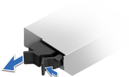
Ilustración 218. Extracción del portaunderes de tarjeta BOSS-N1 DC-MHS de relleno
