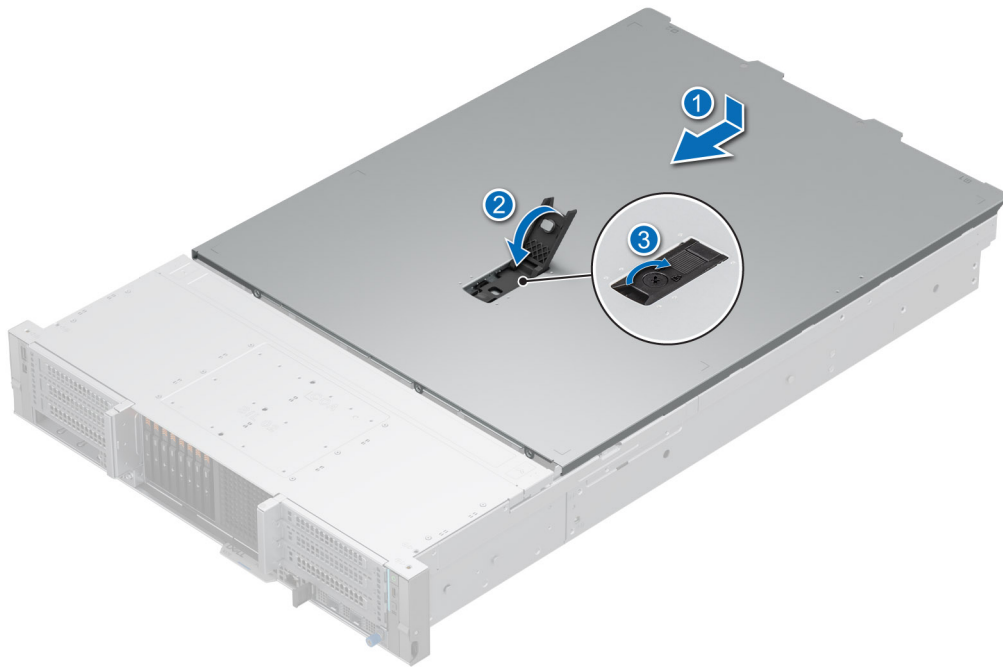
Ilustración 35. Instalación de la cubierta del sistema
