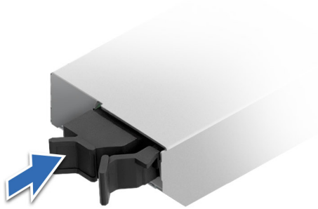
Ilustración 219. Instalación del portaunidades de tarjeta BOSS-N1 DC-MHS de relleno
