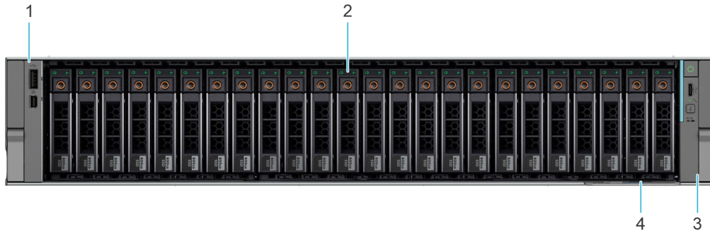
Ilustración 6. Vista frontal de un sistema de 24 unidades de 2,5 pulgadas
