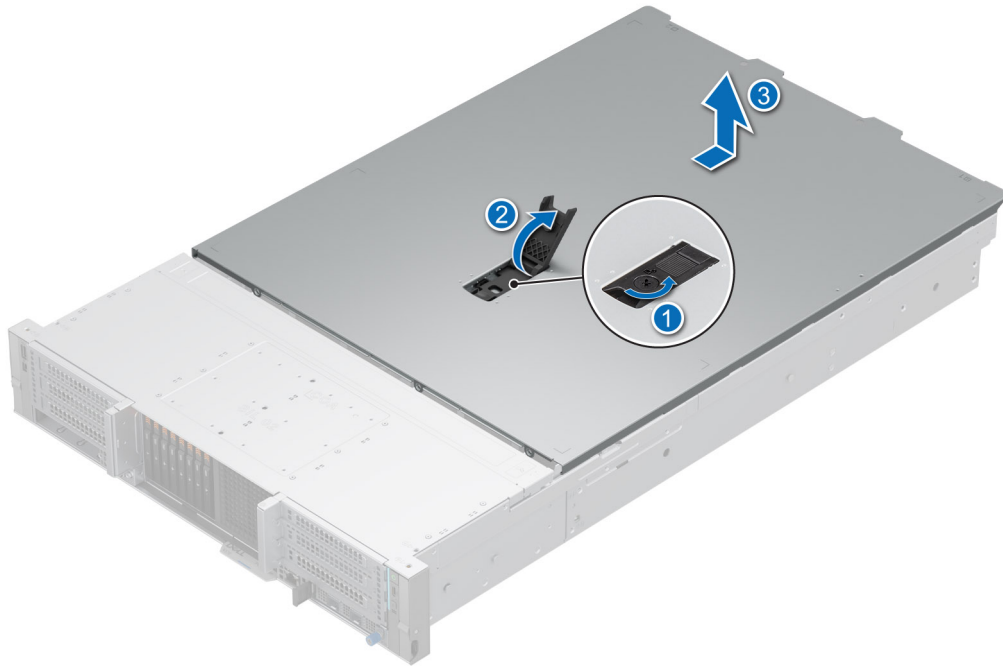
Ilustración 34. Extracción de la cubierta del sistema
