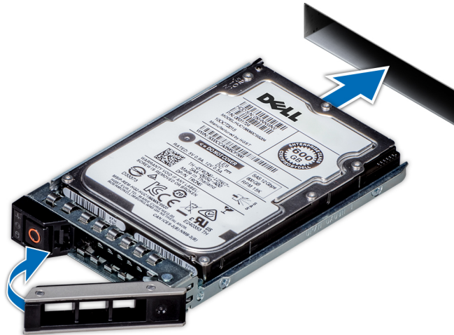
Ilustración 65. Instalación de un portaunidades de disco duro de 3,5 pulgadas
