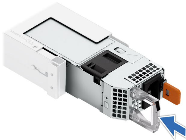
Ilustración 256. Instalación de una fuente de alimentación
