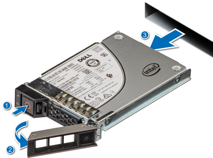
Ilustración 56. Extracción de un portaunidades de disco duro de 2,5 pulgadas
