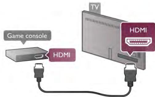
Pour une qualité optimale, utilisez un câble HDMI pour brancher la console de jeux sur le côté du téléviseur.
