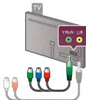
Utilisez le câble adaptateur YPbPr fourni pour connecter votre périphérique. Faites correspondre les couleurs des connecteurs YPbPr (vert, bleu, rouge) avec celles des fiches de câble lors de la connexion.
