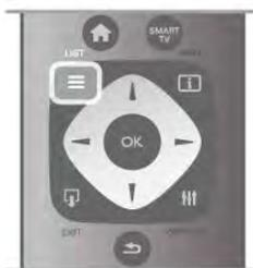
Dans la liste de chaînes, naviguez jusqu'à une chaîne TV ou radio. Une fois l'icône correspondante sélectionnée, appuyez sur **OK** pour regarder la chaîne TV ou écouter la chaîne radio. La liste de chaînes peut comporter plusieurs pages de chaînes. Pour afficher la page suivante ou précédente, appuyez sur **CH-** ou **CH+**.
