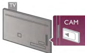
Utilisez le logement Common Interface (Interface commune) situé sur le côté gauche du téléviseur pour insérer la carte CAM\*. Insérez-la doucement le plus loin possible et laissez-la en place. L'activation du CAM peut prendre quelques minutes. Le retrait de la carte CAM entraîne la désactivation du service de diffusion sur le téléviseur.
