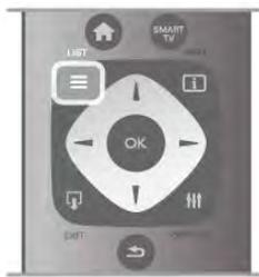
Dans une liste de chaînes, naviguez jusqu'à une chaîne ou station de radio. Une fois l'icône correspondante sélectionnée, appuyez sur **OK** pour regarder la chaîne ou écouter la station de radio.
