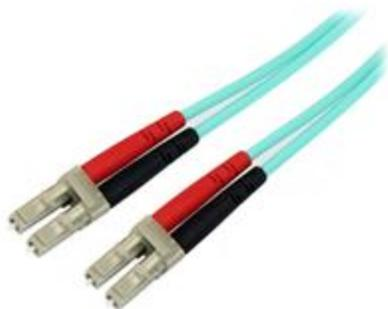
Le câble turquoise à fibre optique optimisée laser multimode A50FBLCLC1 de 1 m 850 nm comprend une fibre optique de 50/125 microns pour des transferts de données haute vitesse et à large bande passante sur les réseaux Ethernet 10 Gb et Fiber Channel. Cela en fait le câble idéal pour les acheminements de câble à fibre optique entre plusieurs commutateurs, hubs et routeurs d'infrastructure, ainsi que de l'équipement réseau plus haut de gamme.
