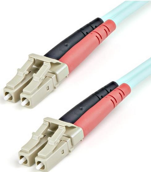
El cable Aqua A50FBLCLC1 1m de fibra multimodo optimizada para láser (LOMMF) de 850nm cuenta con fibra de 50/125 micras para transmisiones de datos de alta velocidad y gran ancho de banda a través de redes Ethernet de 10 Gigabits y de canal de fibra: La solución perfecta para tendidos de cable de fibra entre múltiples conmutadores troncales, concentradores y enrutadores, así como equipos de red de gama alta.
