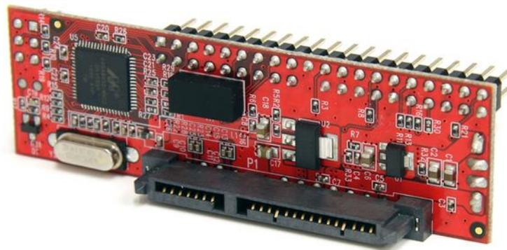
Este adaptador IDE/ATAPI a SATA permite conectar una unidad SATA al puerto IDE/ATA 33/66/100/133 de una placa base.
