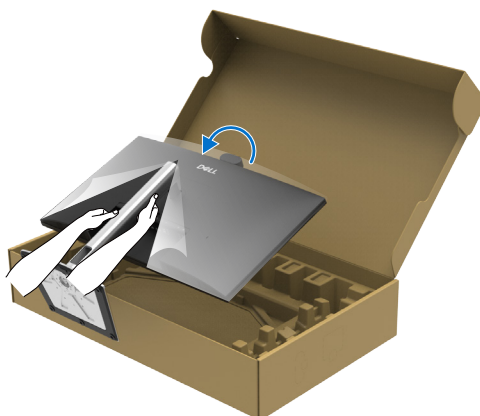
Figure 23. Tenir la colonne du socle et soulever le moniteur
