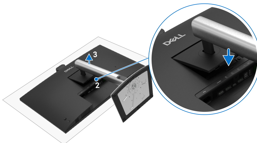
Figure 60. Retrait du socle du moniteur
