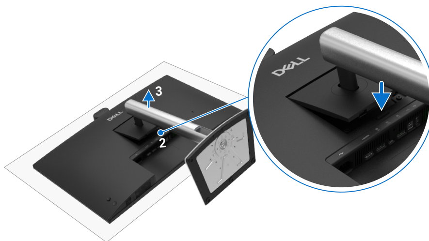
Figura 60. Desmontaje del soporte del monitor
