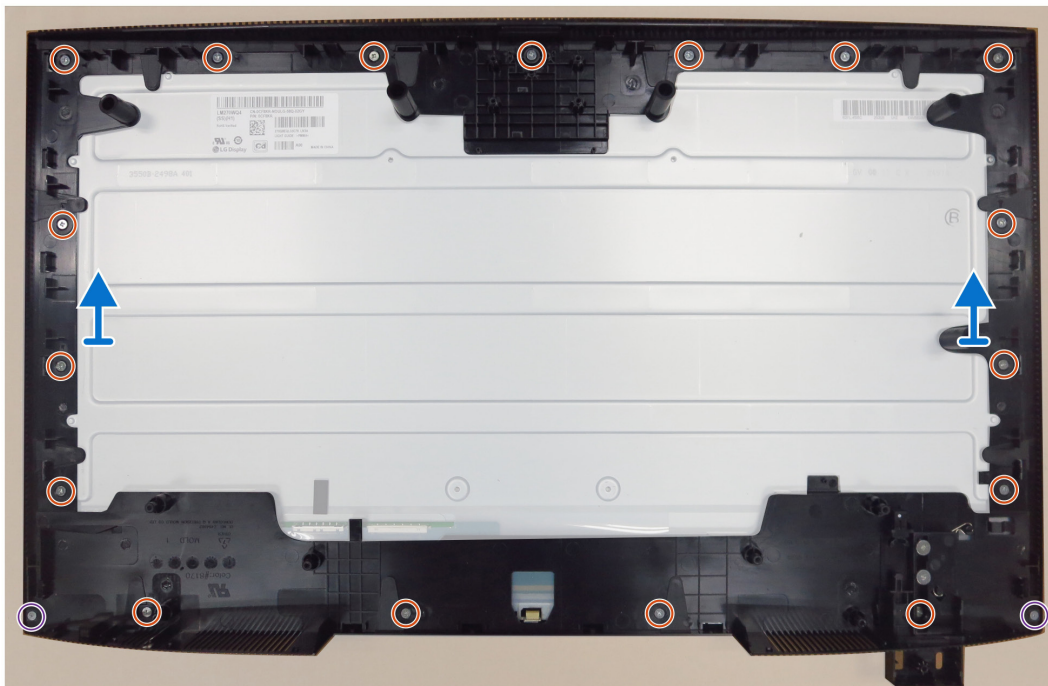
Figura 30. Desmontaje del marco central
