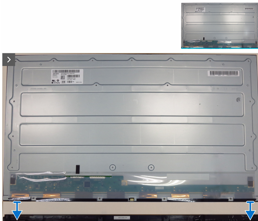
Figura 32. Desmontaje del embellecedor frontal
