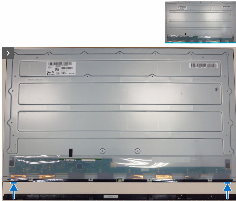
Figura 18. Instalación del embellecedor frontal
