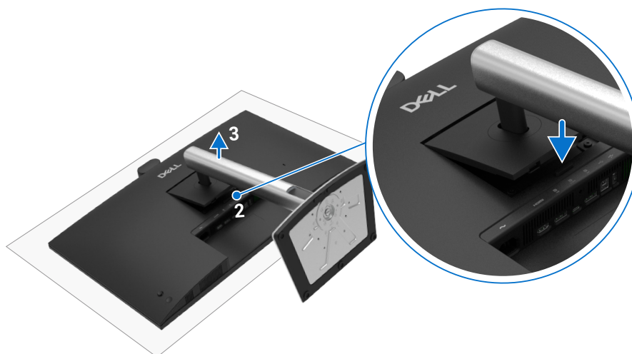
Figure 60. Retrait du socle du moniteur
