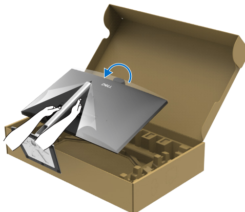
Figura 23. Sujete el elevador del soporte y levante el monitor
