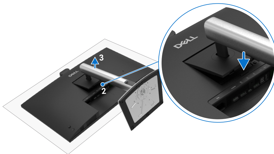
Figura 60. Desmontaje del soporte del monitor
