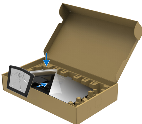
Figura 22. Inserte las lengüetas del elevador del soporte en las ranuras
