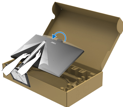
Figur 23. Håll i höjledsjusteringen och lyft bildskärmen
