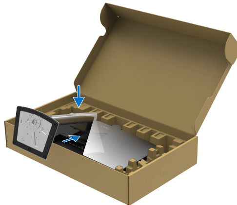
Figur 22. Skjut in flikarna på höjledsjusteringen i spåren
