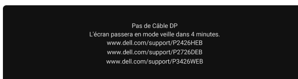
Figure 102. Message d'avertissement de câble DP débranché
