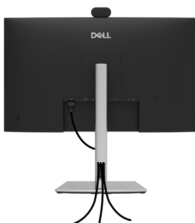
Figure 57. Rangement des câbles
