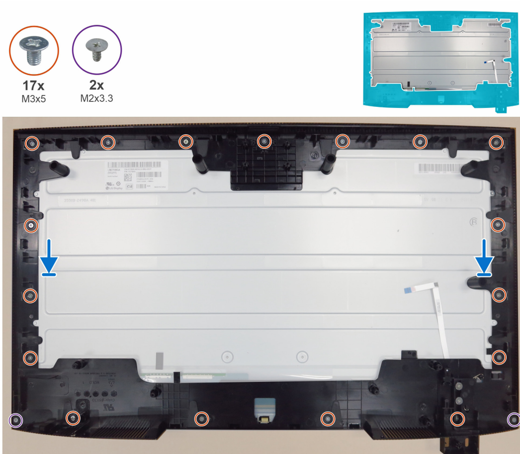
Figure 33. Installation du cadre intermédiaire
