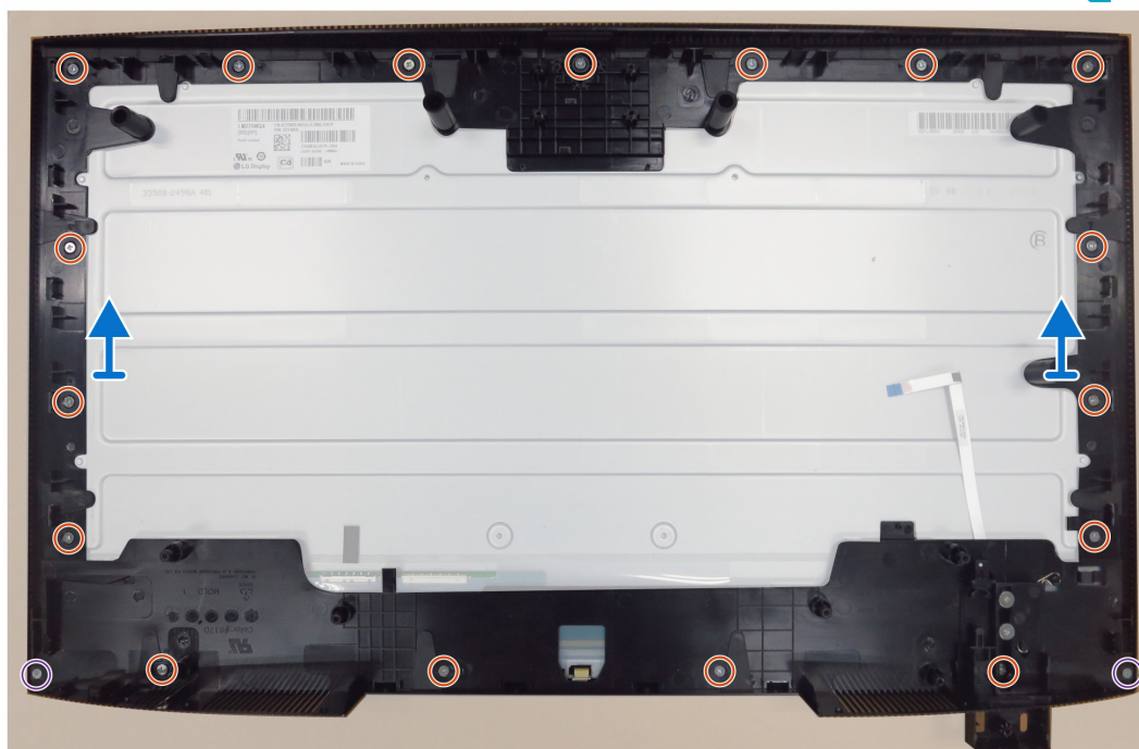
Obrázek 32. Demontáž středového rámečku
