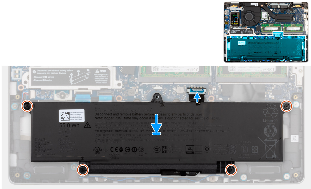
Abbildung 20. Verbinden des Akkukabels
