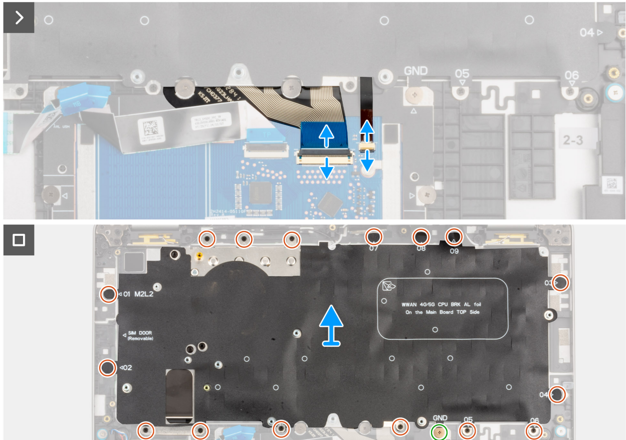
Abbildung 68. Entfernen der Tastatur
