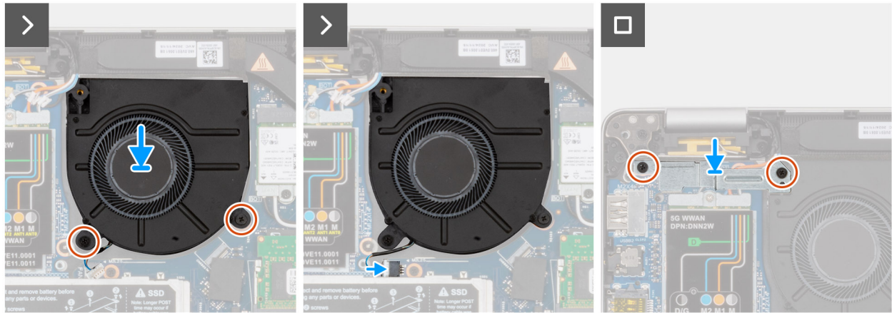
Abbildung 44. Einbauen des Lüfters
