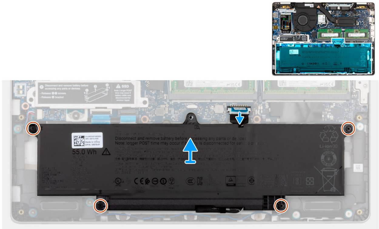
Abbildung 19. Trennen des Akkukabels
