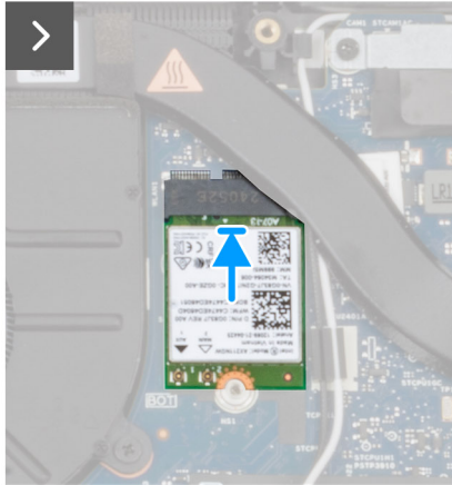
Abbildung 36. Einbauen der WLAN-Karte
