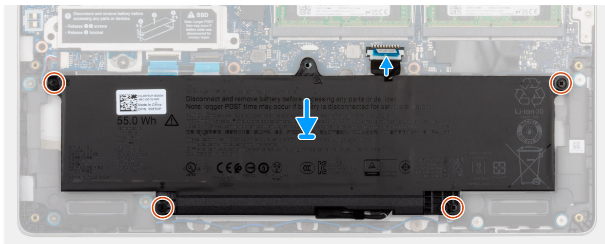
Abbildung 24. Einsetzen des Akkus
