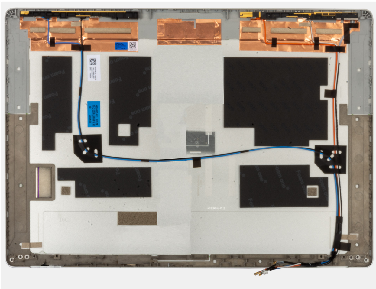
Ilustración 76. Instalación de la cubierta posterior de la pantalla
