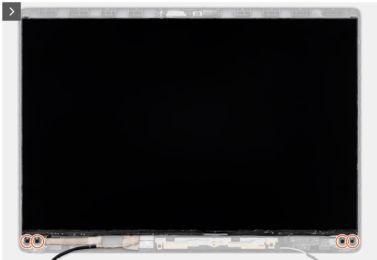
Ilustración 58. Extracción del panel de pantalla
