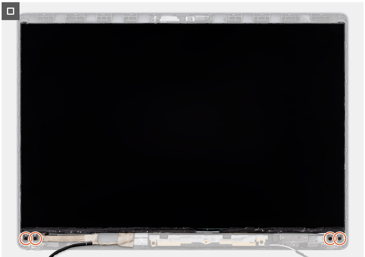
Ilustración 64. Instalación del panel de pantalla
