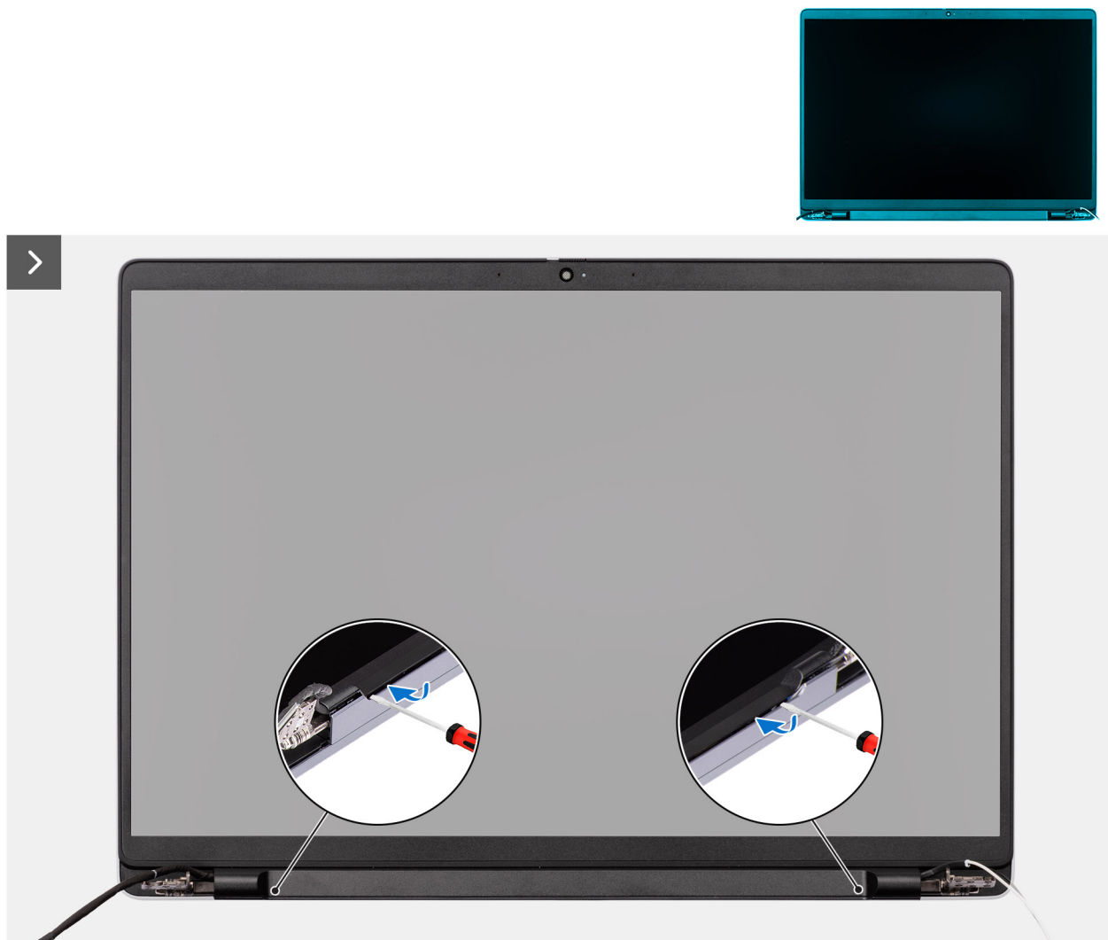
Ilustración 50. Extracción del embellecedor de la pantalla
