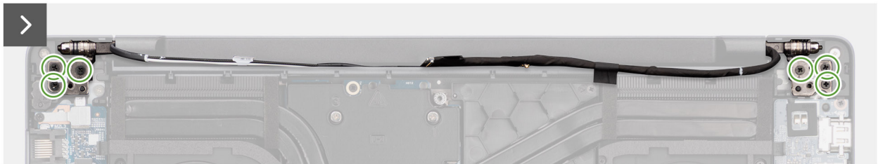
Ilustración 48. Instalación del ensamblaje de la pantalla
