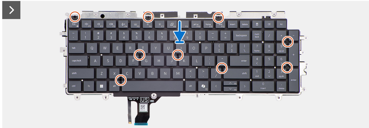
Ilustración 85. Instalación del teclado
