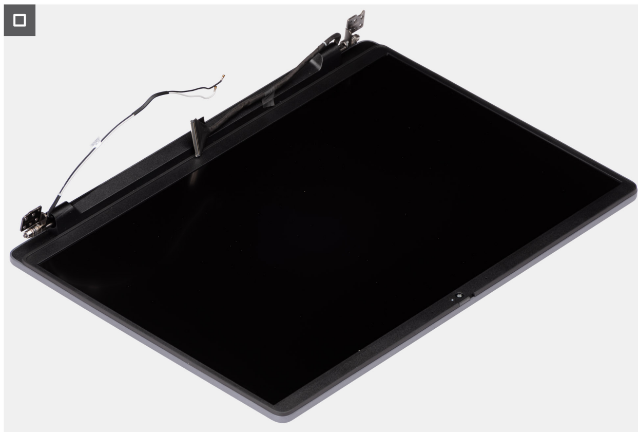
Ilustración 46. Ensamblaje de la pantalla
