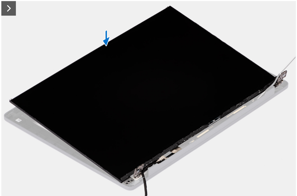
Ilustración 63. Instalación del panel de pantalla
