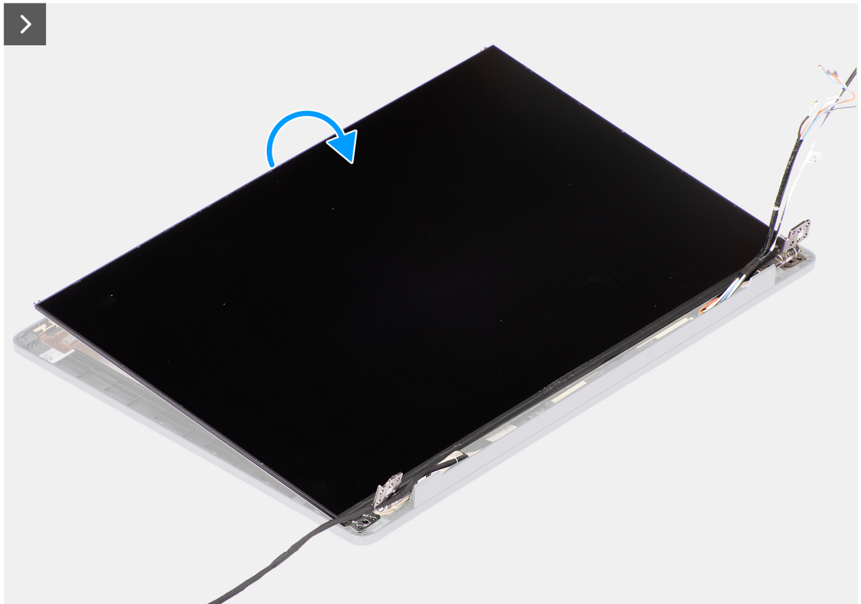
Ilustración 69. Extracción del panel de pantalla
