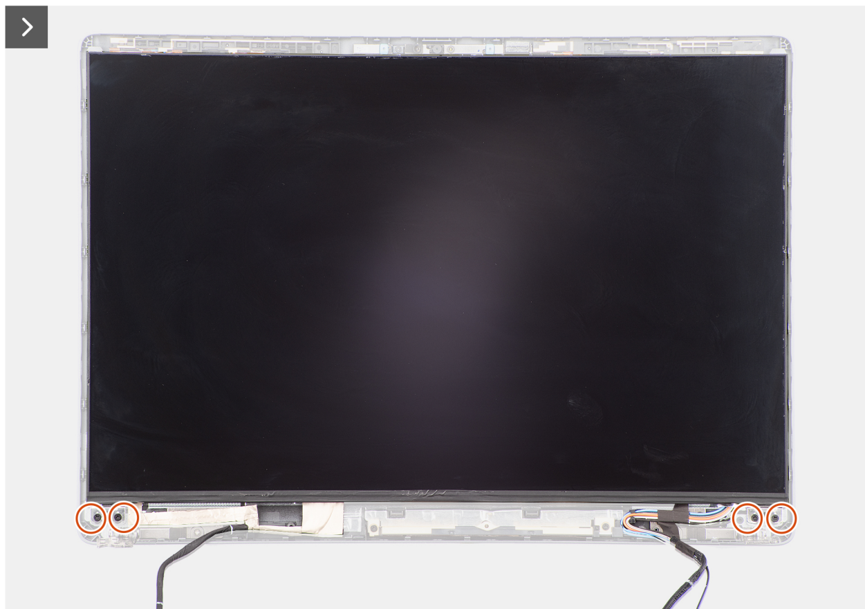
Ilustración 68. Extracción del panel de pantalla
