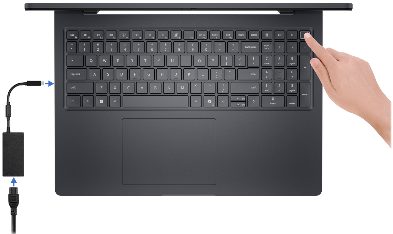
Ilustración 8. Conecte el adaptador de alimentación y presione el botón de encendido
