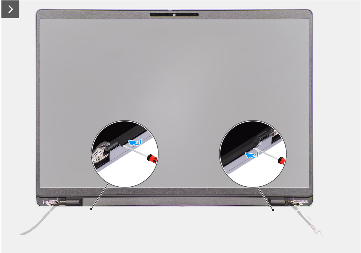
Ilustración 60. Extracción del embellecedor de la pantalla
