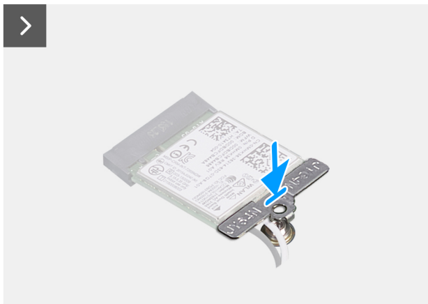
Ilustración 28. Instalación de la tarjeta inalámbrica
