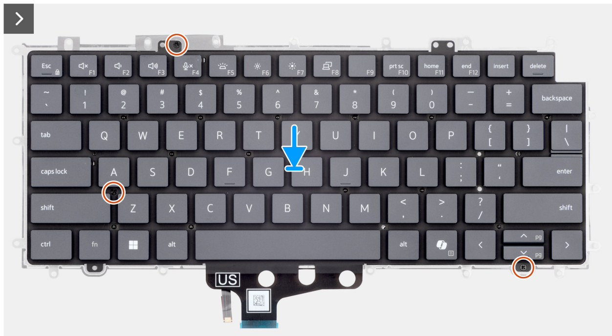
Ilustración 97. Installing the keyboard
