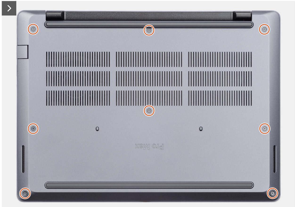
Ilustración 11. Extracción de la cubierta de la base
