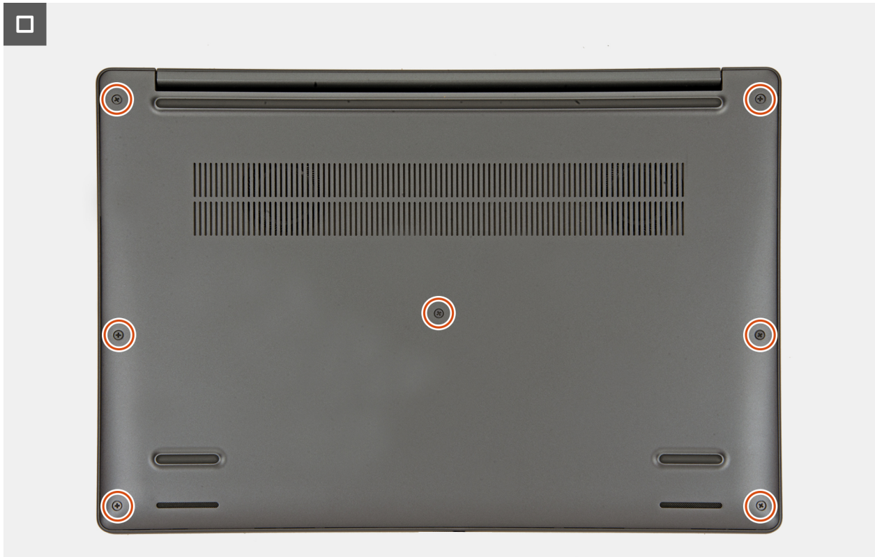
Ilustración 21. Ajuste de los tornillos cautivos
