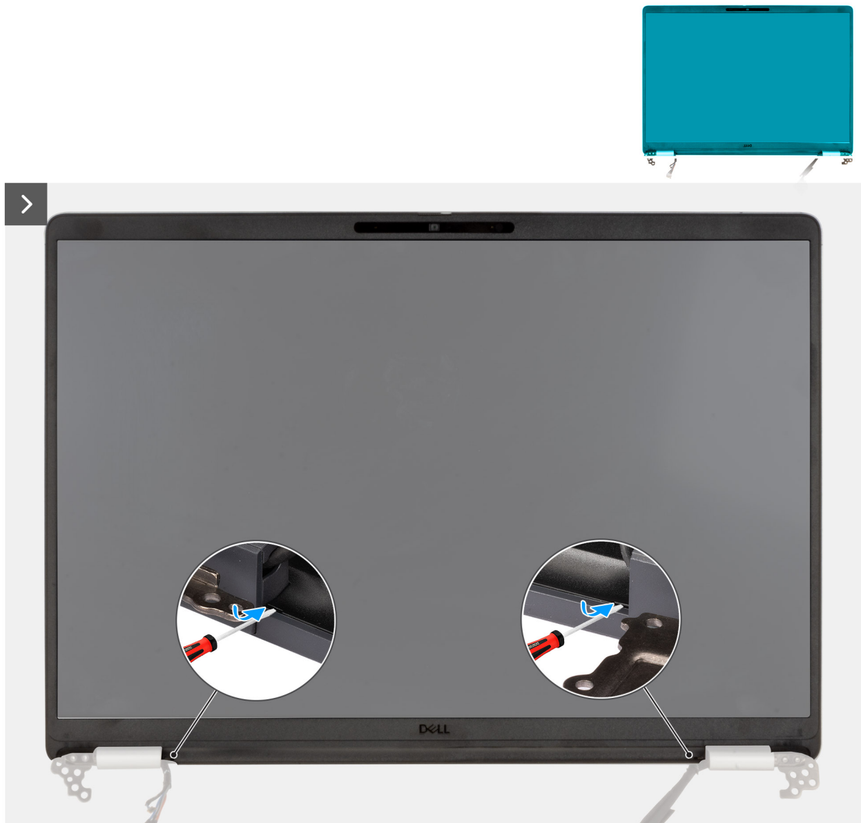
Ilustración 64. Hacer palanca en el bisel de plástico
