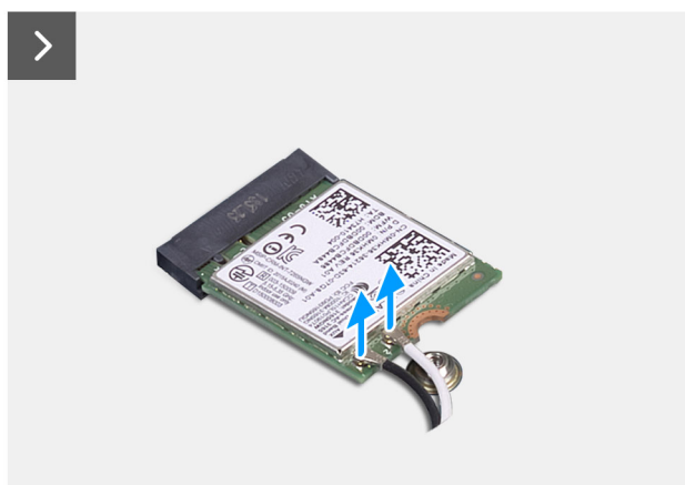
Ilustración 35. Extracción de la tarjeta WLAN
