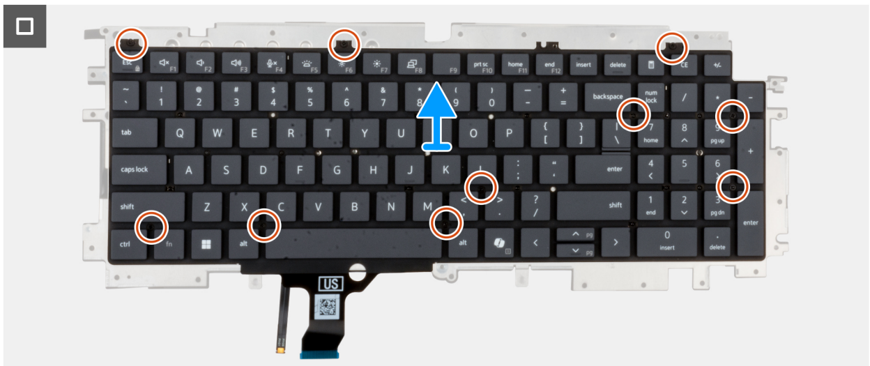
Ilustración 85. Extracción del teclado
