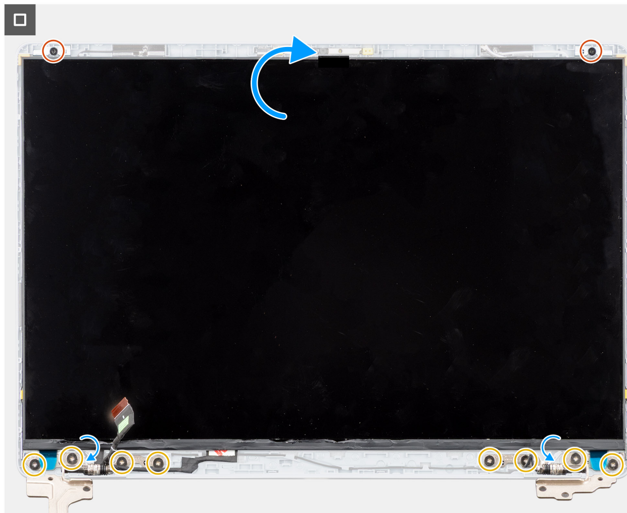
Ilustración 65. Instalación del panel de pantalla
