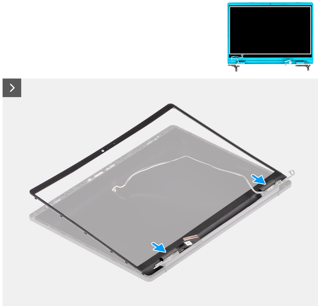
Ilustración 61. Instalación del bisel de la pantalla
