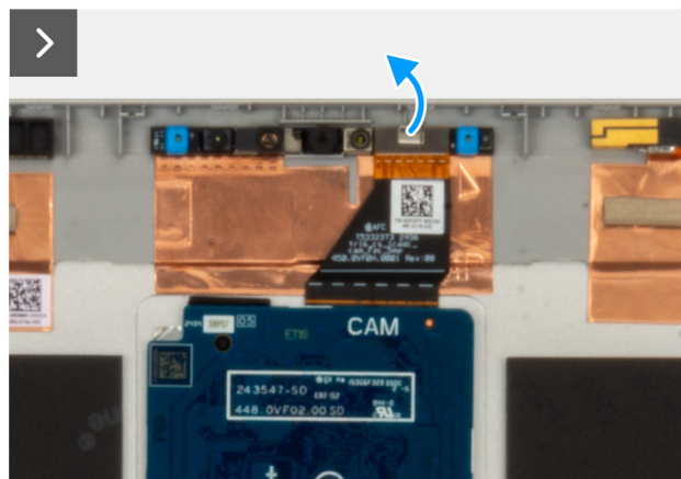
Afbeelding 69. De cameramodule verwijderen
