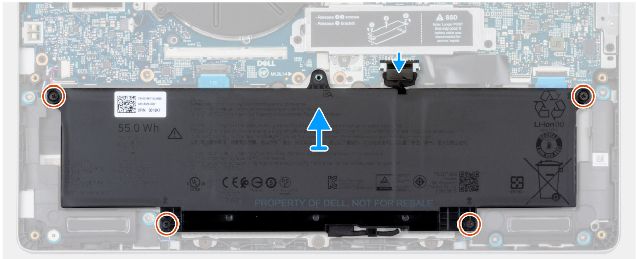
Afbeelding 15. De batterijkabel loskoppelen
