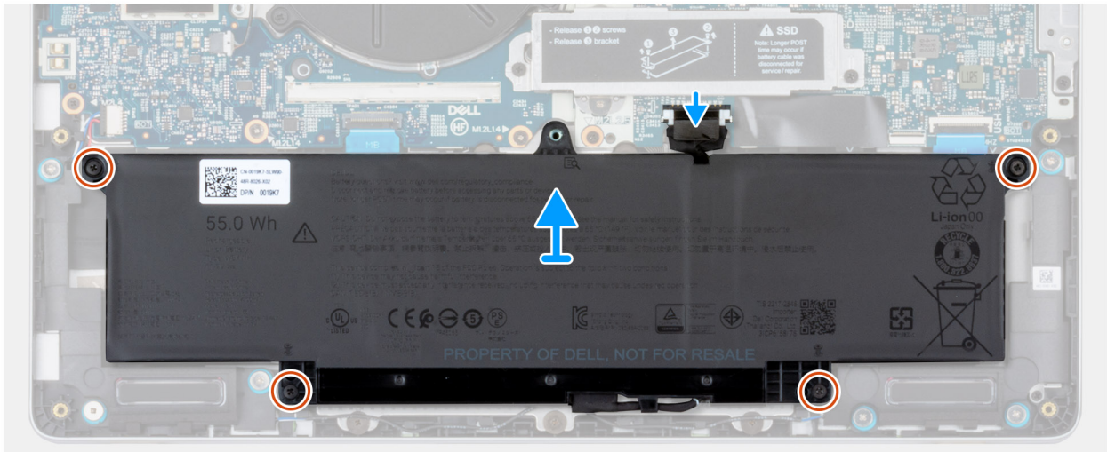
Afbeelding 19. De batterij verwijderen
