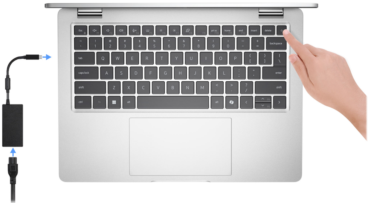
Afbeelding 7. Sluit de netadapter aan en druk op de aan-uitknop.
