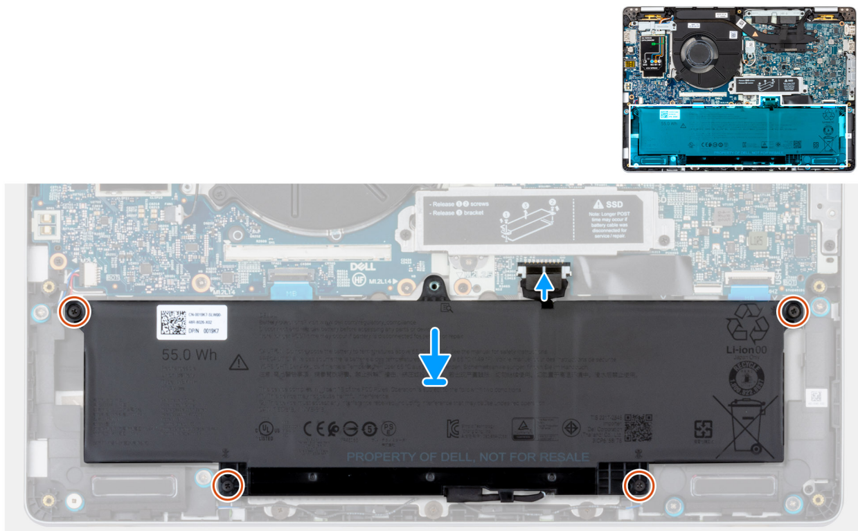
Afbeelding 16. De batterijkabel aansluiten
