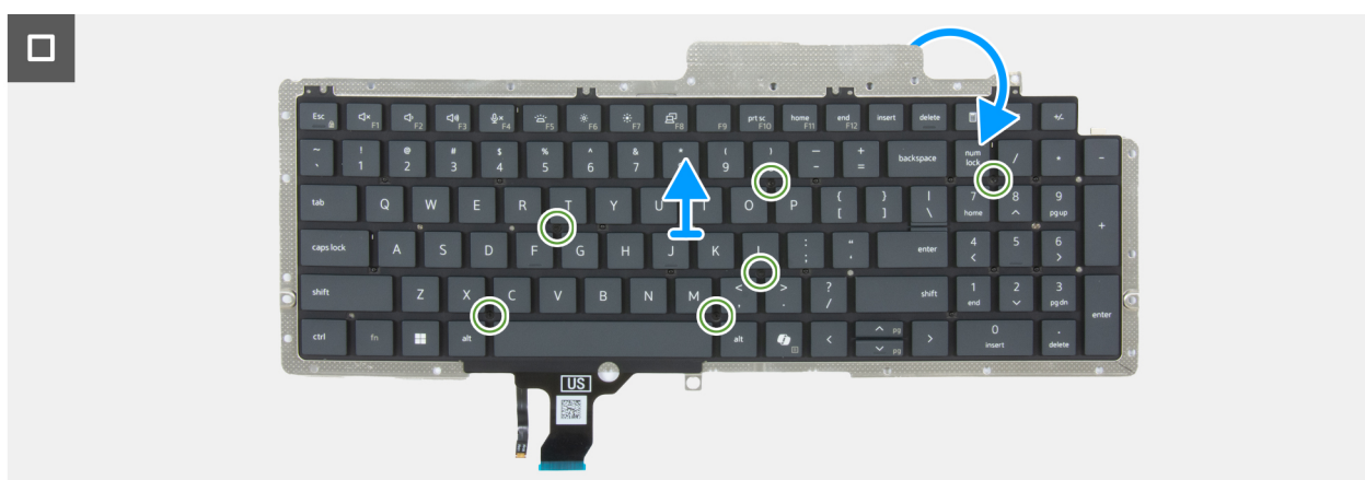
Afbeelding 118. Het toetsenbord verwijderen
