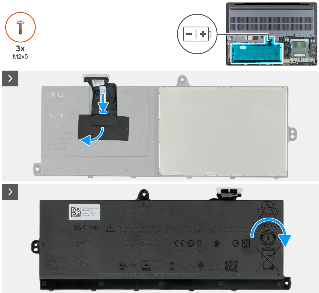
Afbeelding 46. De batterijkabel vervangen
