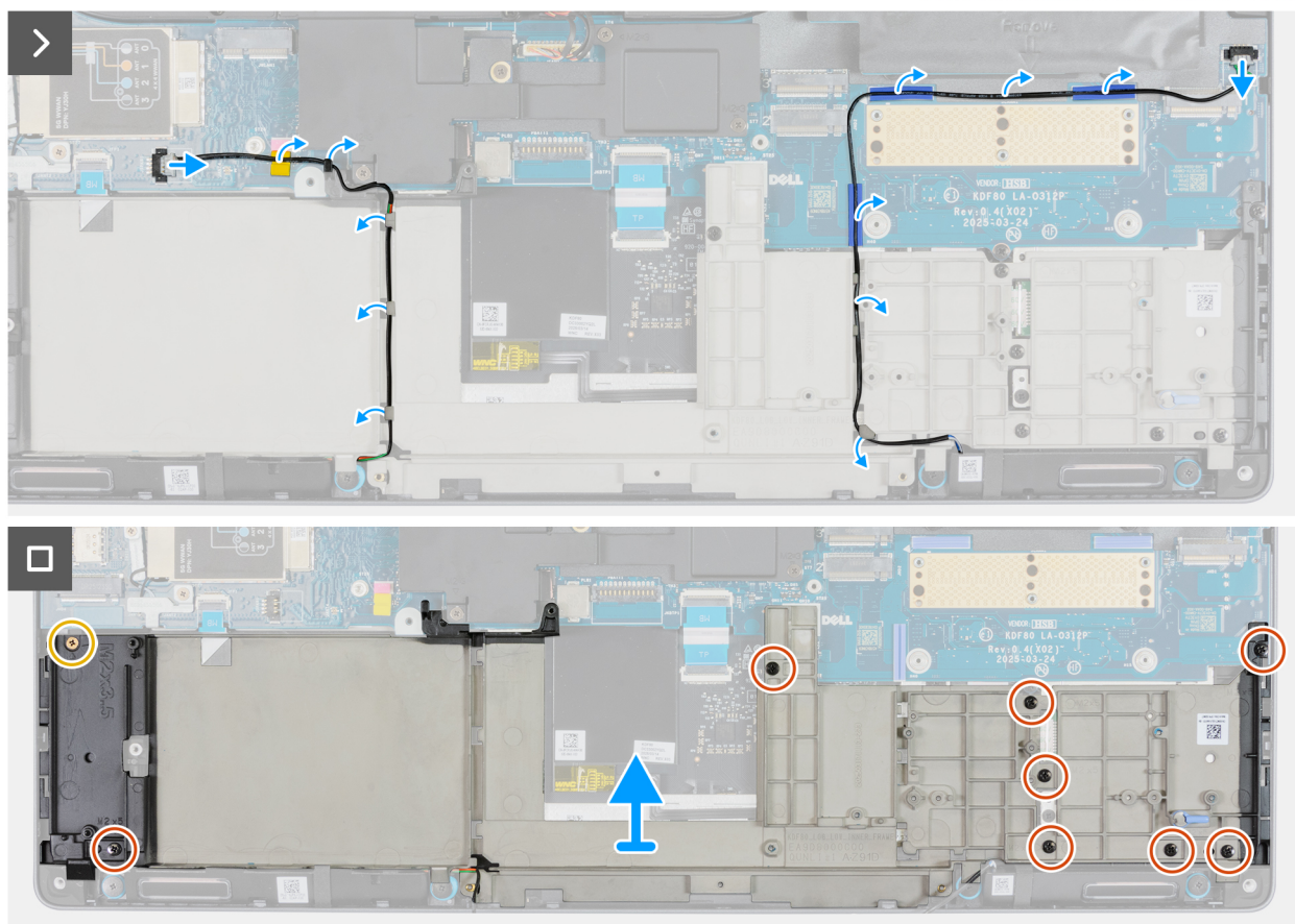
Afbeelding 79. Het binnenframe verwijderen
