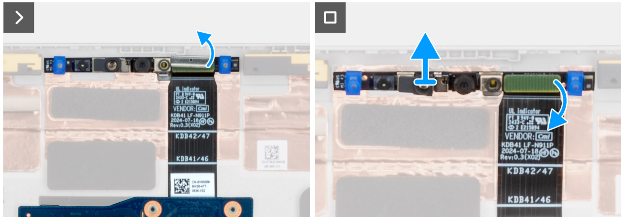
Afbeelding 88. De MIPI-camera verwijderen
