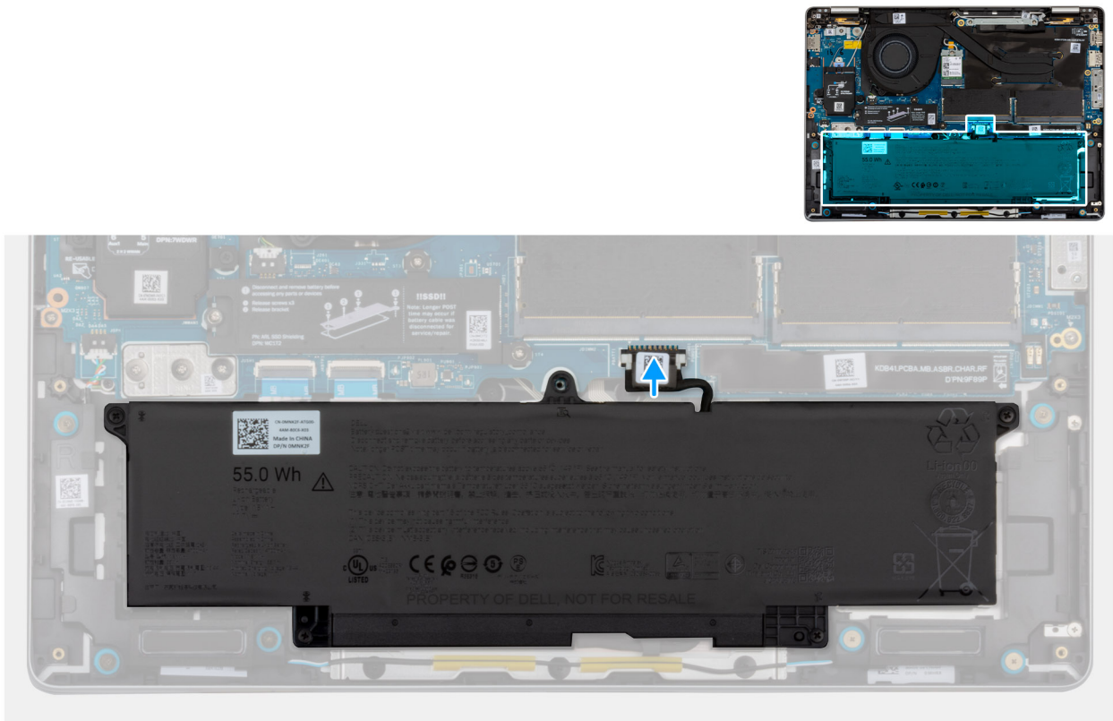
Afbeelding 25. De batterijkabel aansluiten
