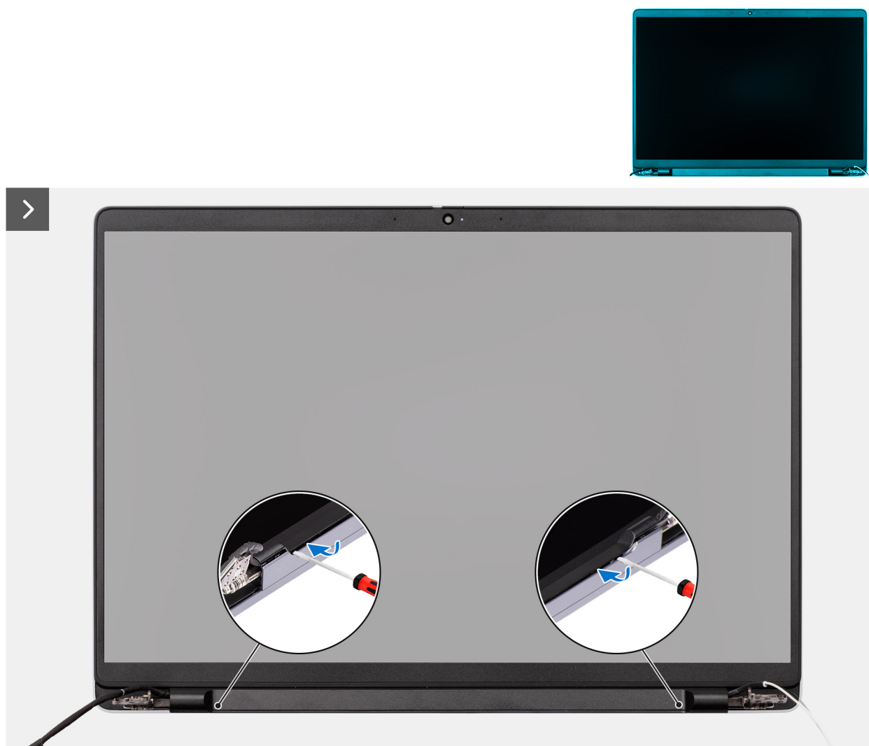
Afbeelding 50. De beeldschermbezel verwijderen
