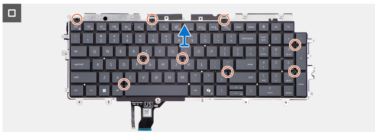
Afbeelding 84. Het toetsenbord verwijderen
