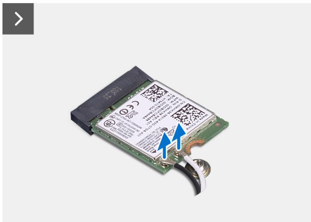
Afbeelding 25. De draadloze kaart verwijderen
