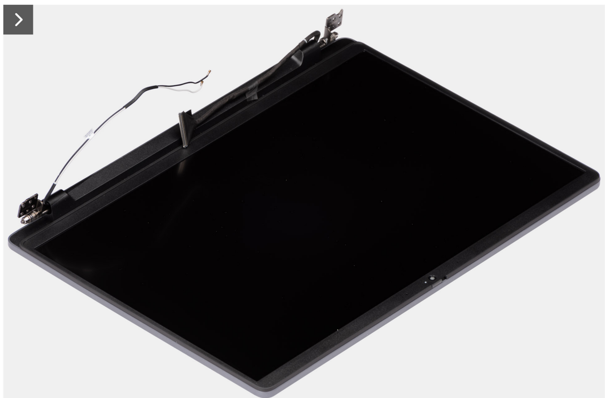
Afbeelding 47. De beeldschermeenheid installeren
