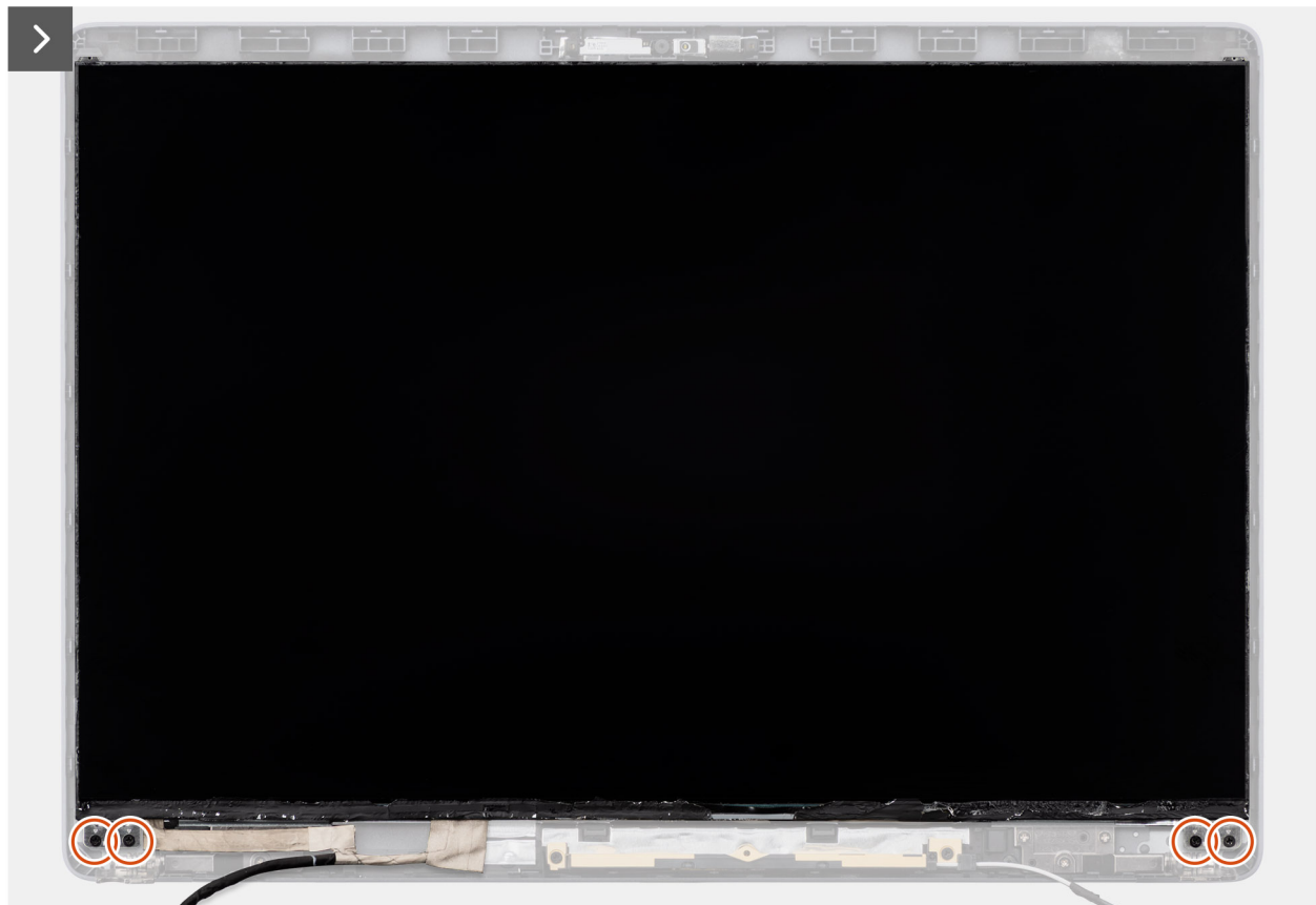
Afbeelding 58. Het beeldschermpaneel verwijderen
