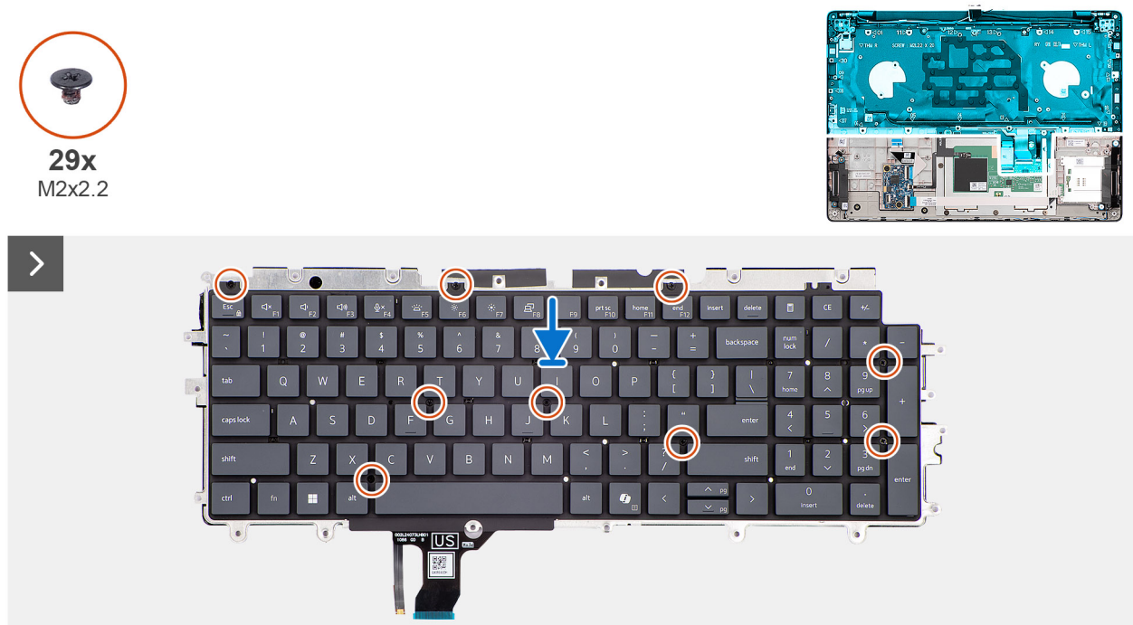
Afbeelding 85. Het toetsenbord installeren
