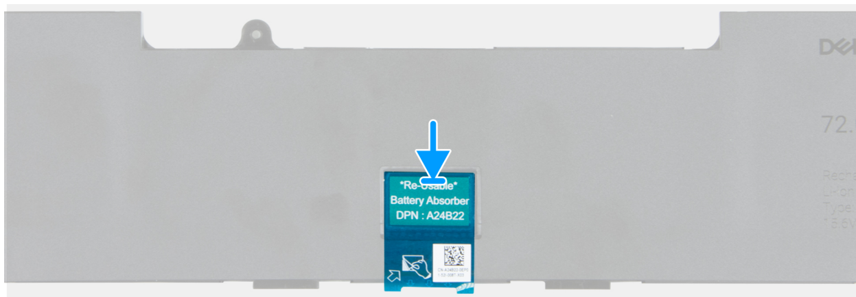
Afbeelding 20. De batterijabsorber installeren
