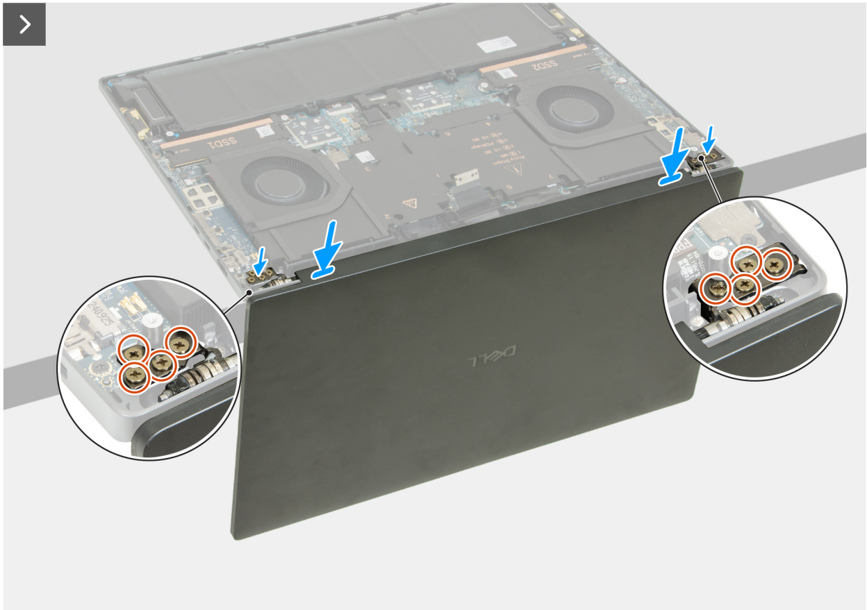
Afbeelding 42. De beeldschermeenheid installeren
