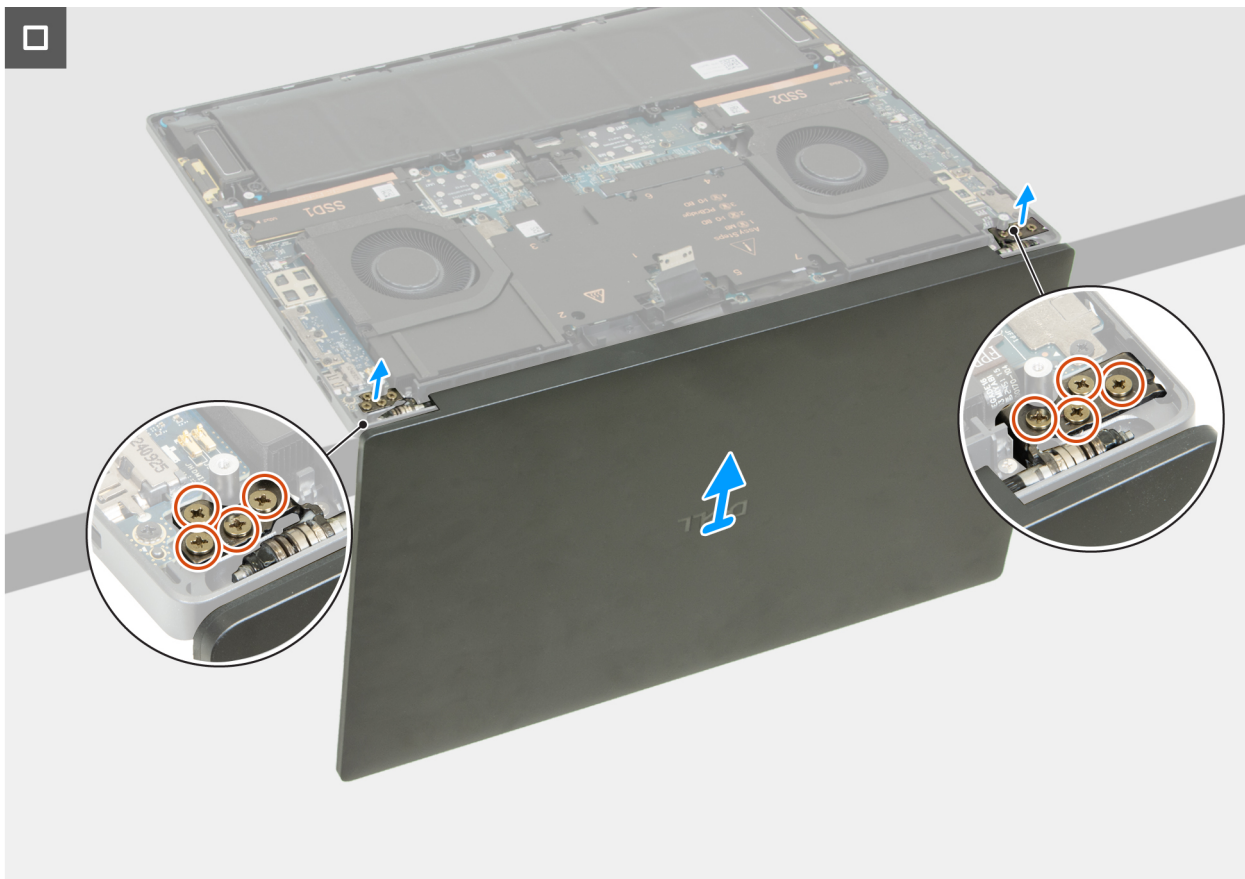
Afbeelding 35. De beeldschermenheid verwijderen
