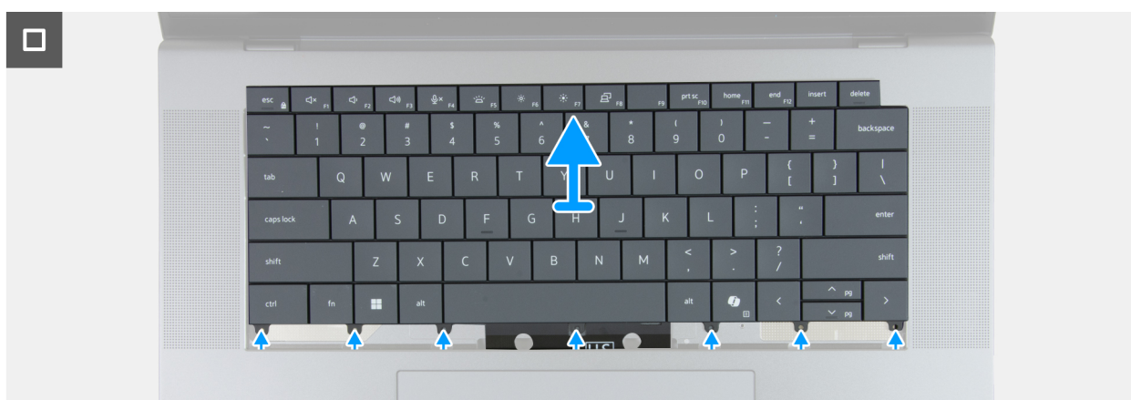
Afbeelding 77. Het toetsenbord verwijderen
