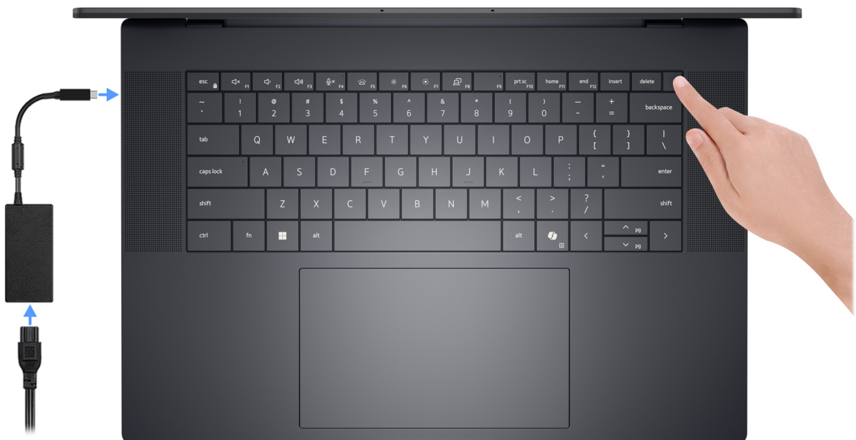
Afbeelding 8. Sluit de netadapter aan en druk op de aan-uitknop.
