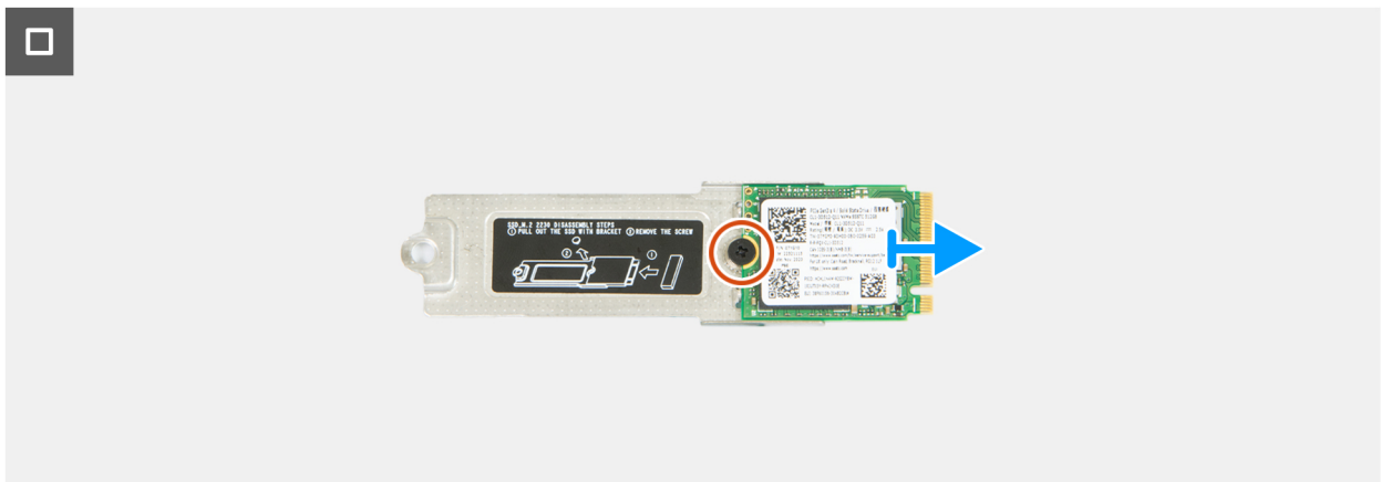
Afbeelding 26. De M.2 2230 SSD (SSD1) verwijderen
