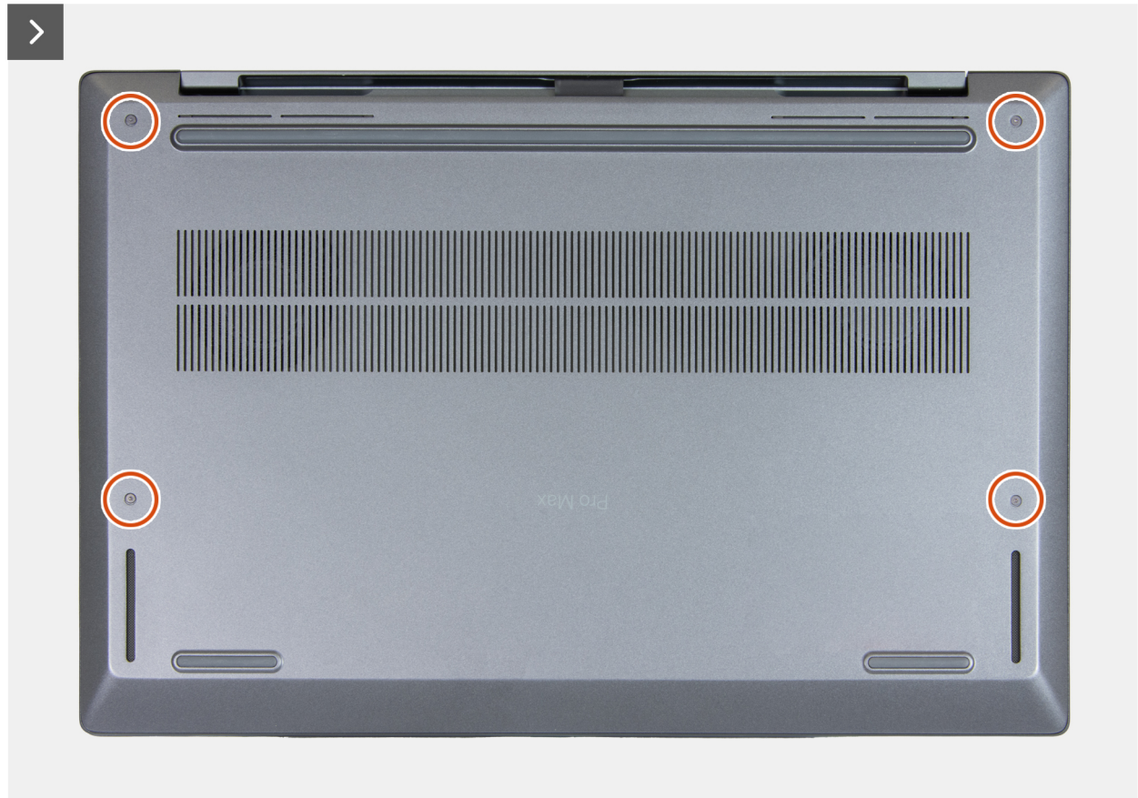
Afbeelding 13. De onderplaat verwijderen
