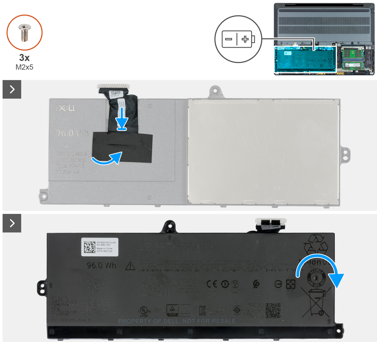
Figure 42. Remplacement du câble de la batterie
