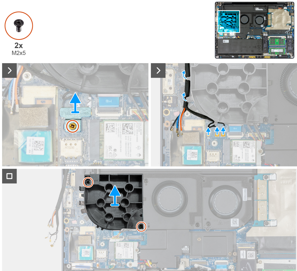
Figure 57. Retrait du ventilateur factice
