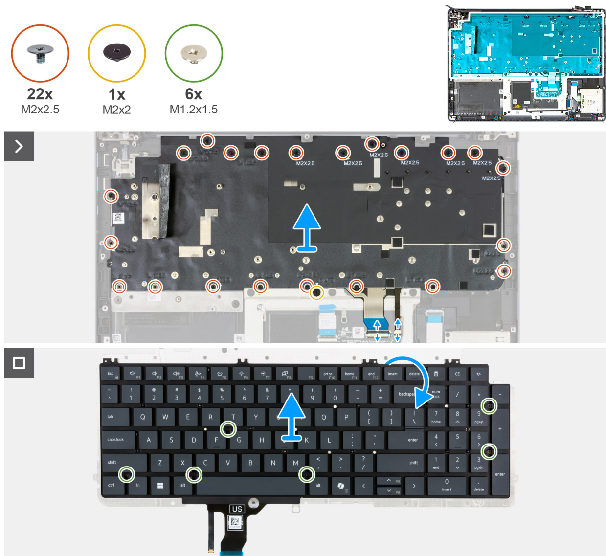
Figure 122. Retrait du clavier
