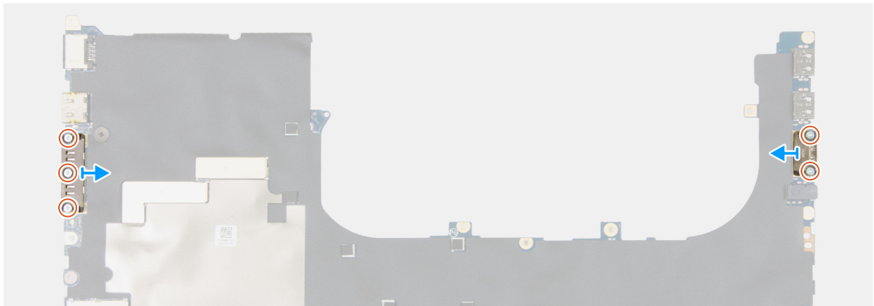
Afbeelding 118. De USB Type-C-connectormodule verwijderen
