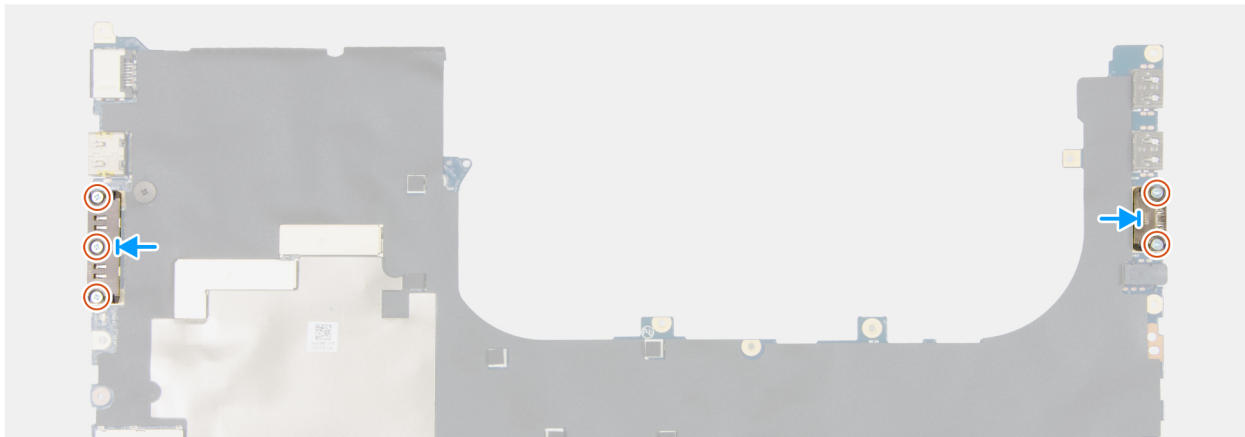
Afbeelding 119. De USB Type-C-connectormodule installeren
