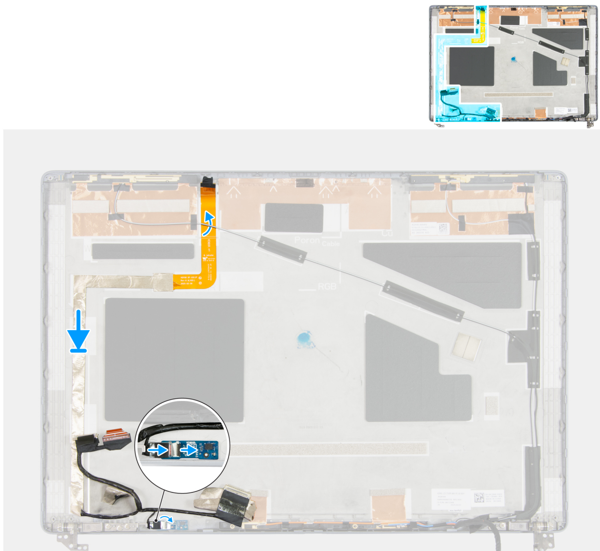
Afbeelding 108. De beeldschermkabel installeren
