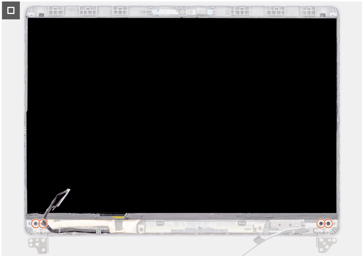
Afbeelding 65. Het beeldschermpaneel installeren
