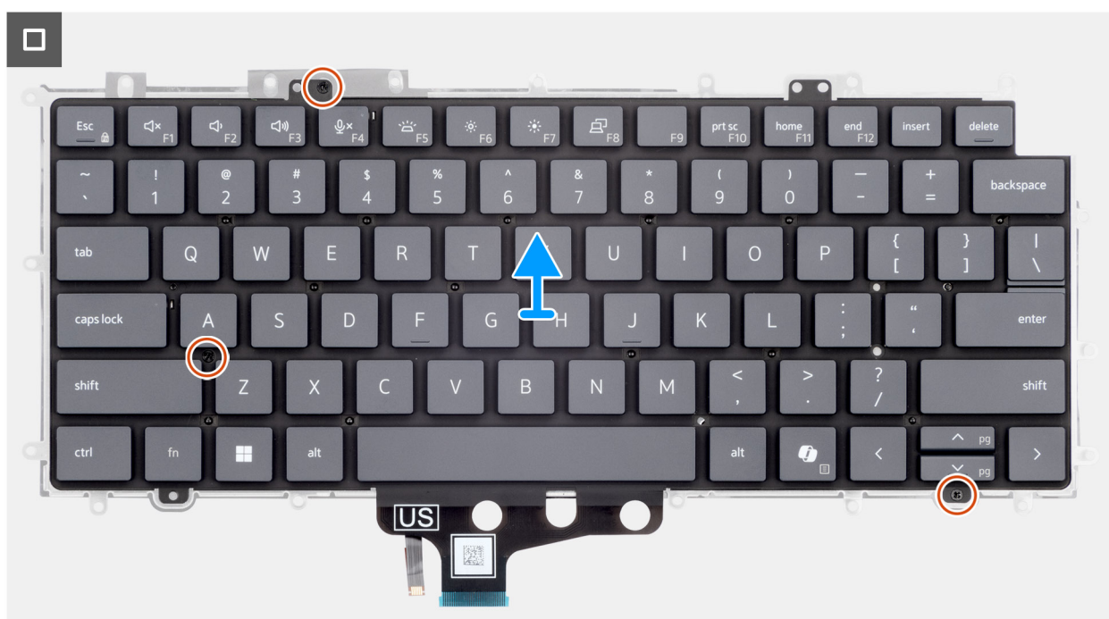
Afbeelding 96. Het toetsenbord verwijderen
