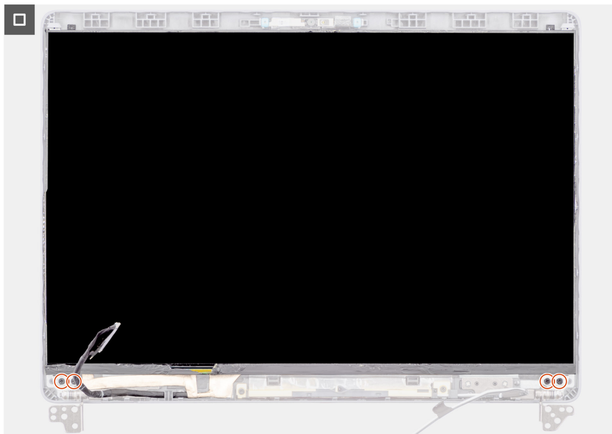
Figure 61. Installation du panneau d'écran
