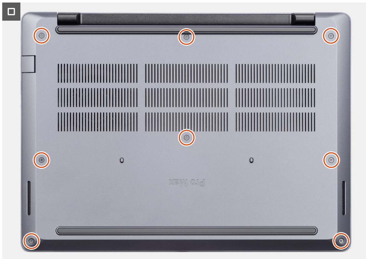
Figure 15. Installation du cache de fond
