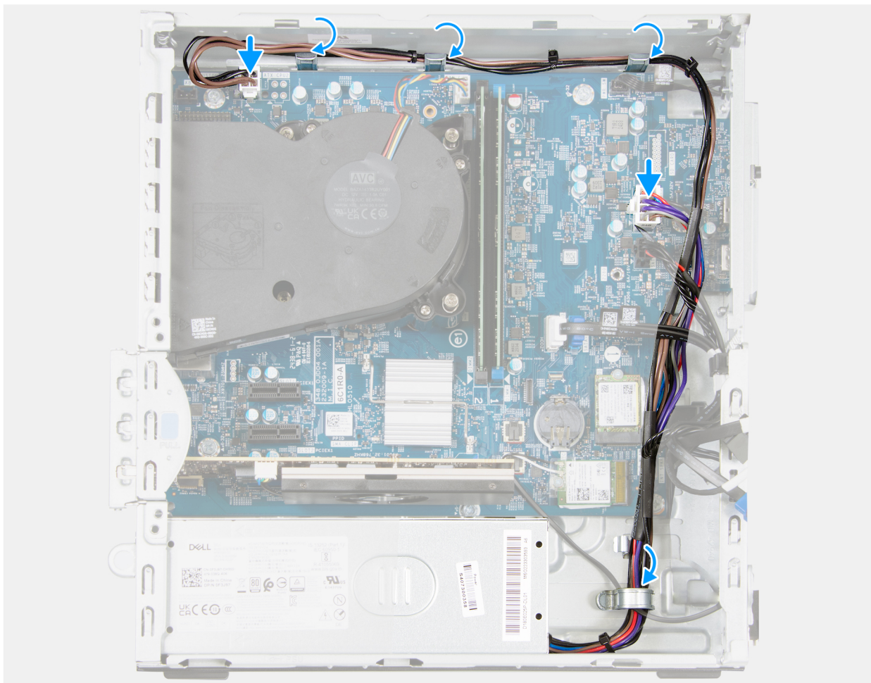
Figure 51. Installation du bloc d'alimentation
