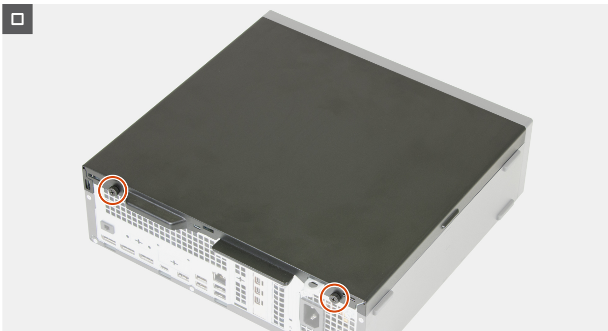
Figure 9. Installation du panneau latéral
