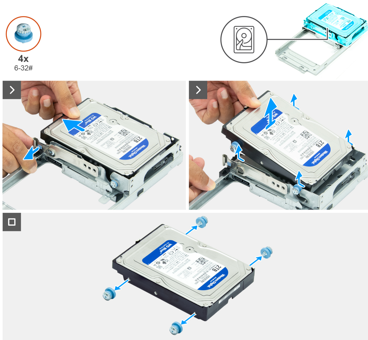
Figure 40. Retrait du disque dur
