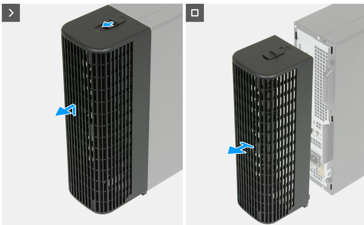
Figure 4. Retrait de la gaine de câble
