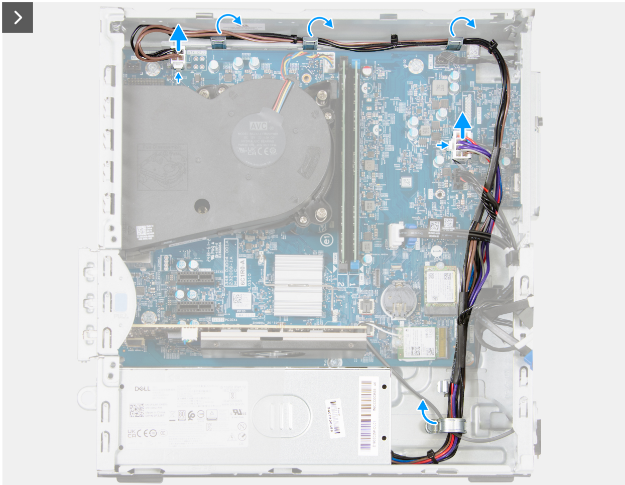
Figure 48. Retrait du bloc d'alimentation
