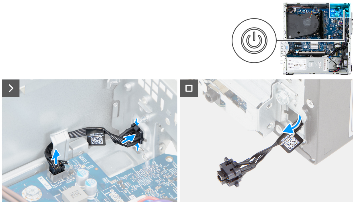
Figure 44. Retrait du bouton d'alimentation
