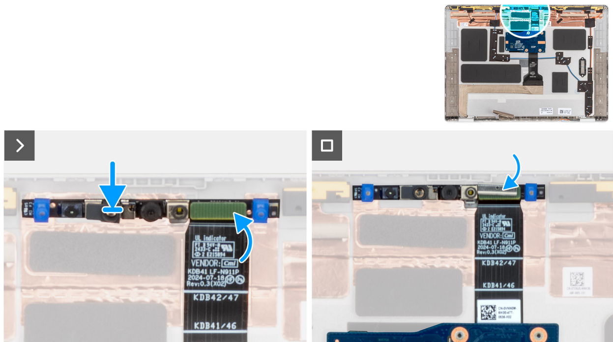
Figure 89. Installation de la caméra MIPI
