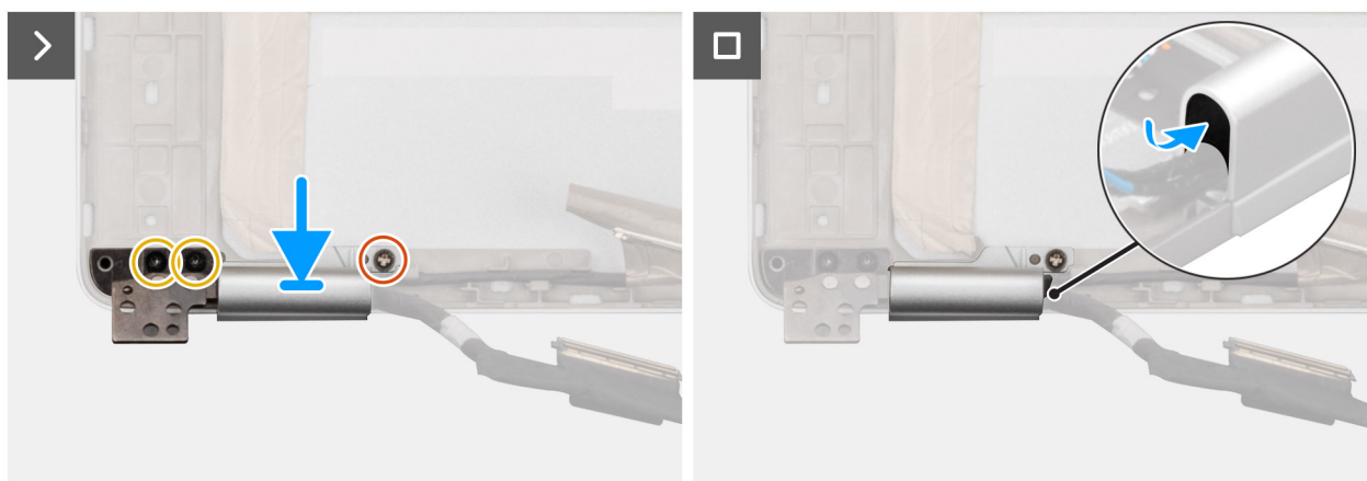
Figure 88. Installation du câble d'écran de la caméra IR/RVB
