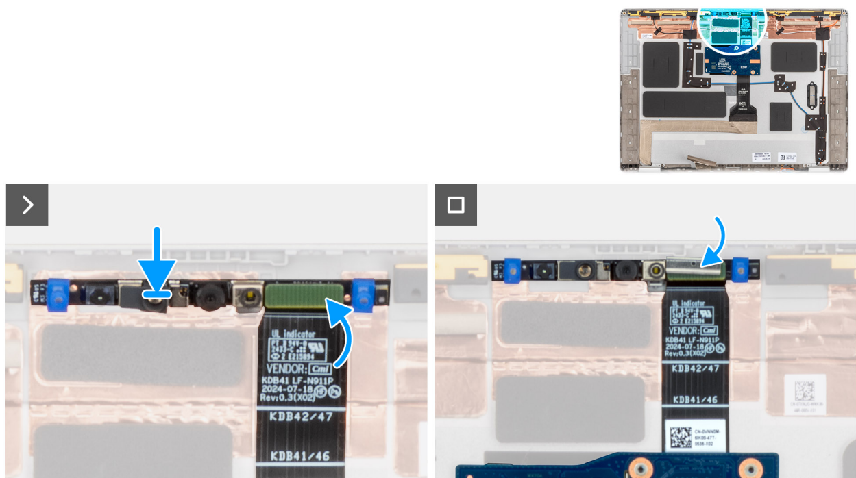
Figure 84. Installation de la caméra MIPI
