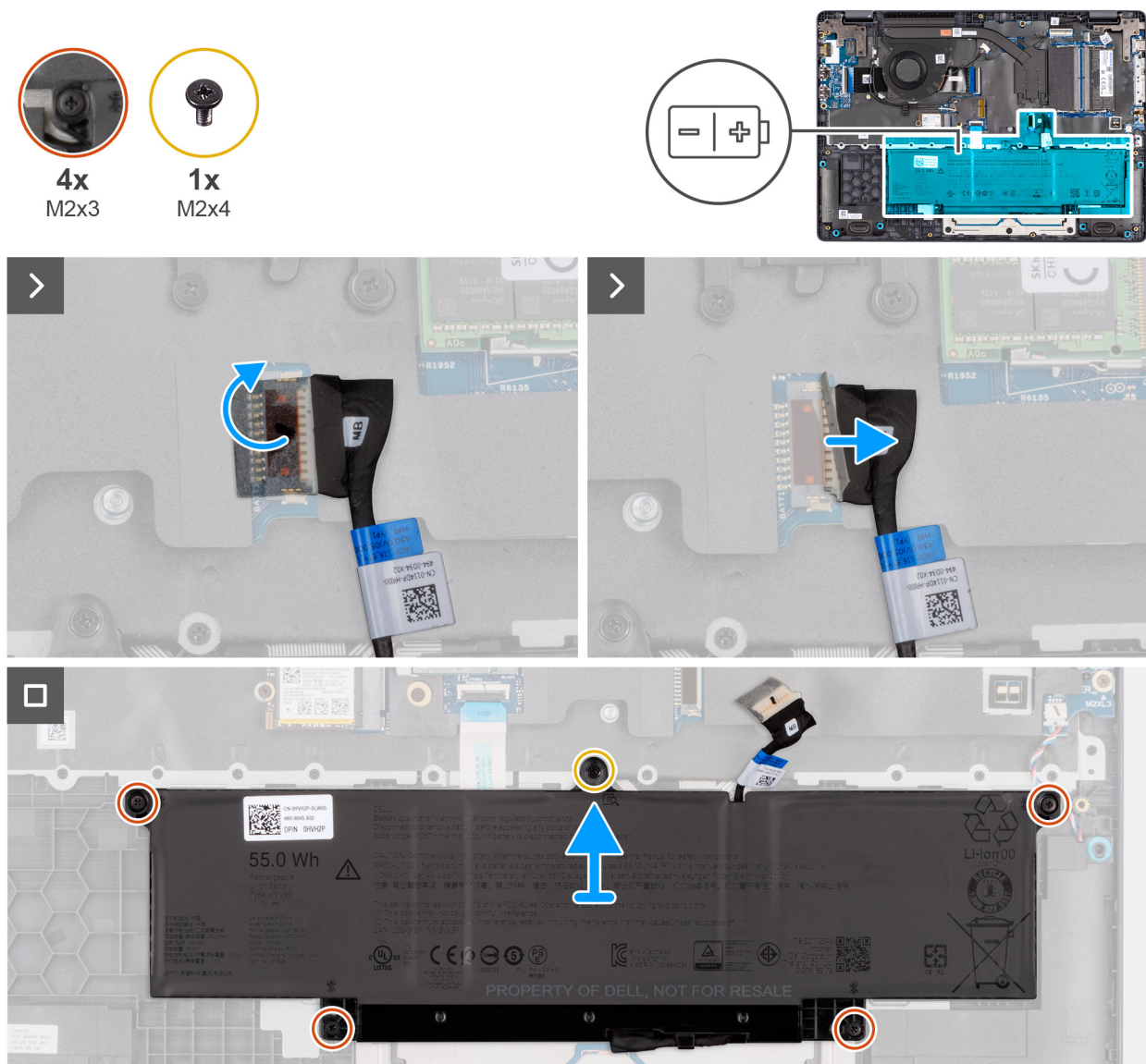
Figure 17. Retrait de la batterie
