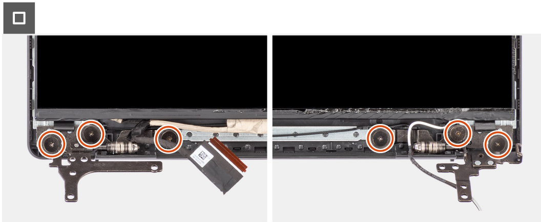
Figure 71. Installation du panneau d'écran
