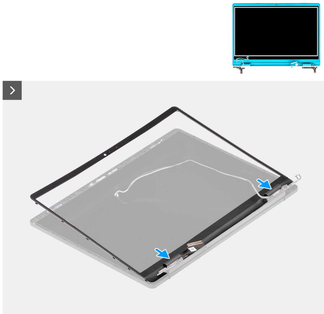
Figure 61. Installation de la bordure d'écran
