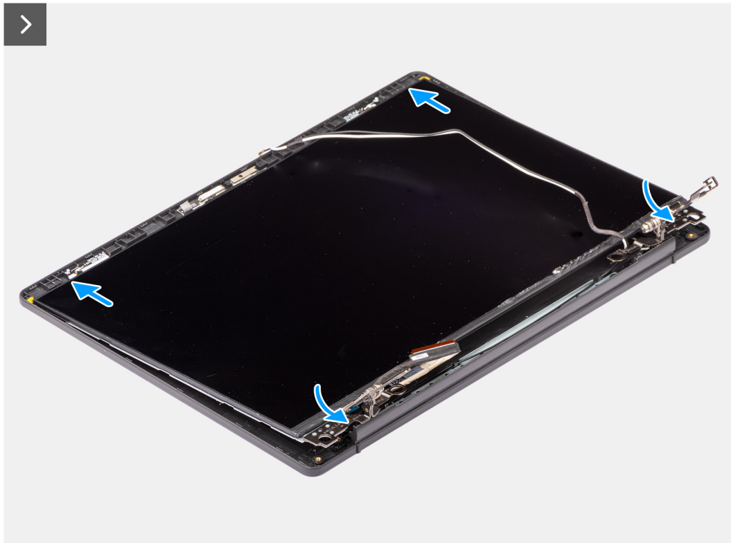
Figure 69. Installation du panneau d'écran
