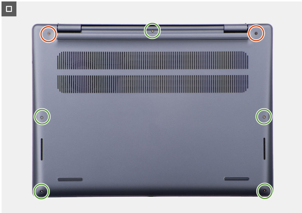
Figure 14. Installation du cache de fond
