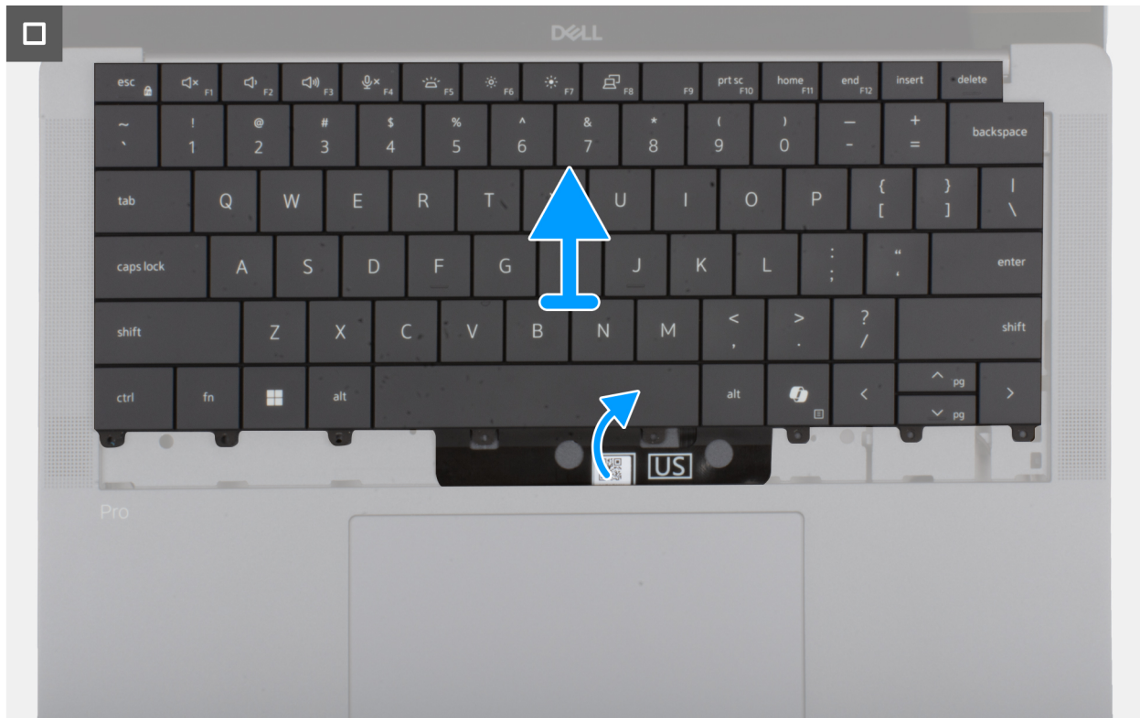
Figure 74. Retrait de l'assemblage du clavier
