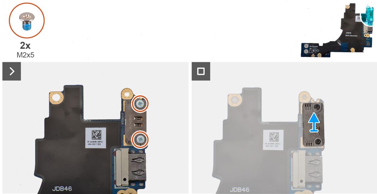
Figure 52. Retrait du module USB-C gauche
