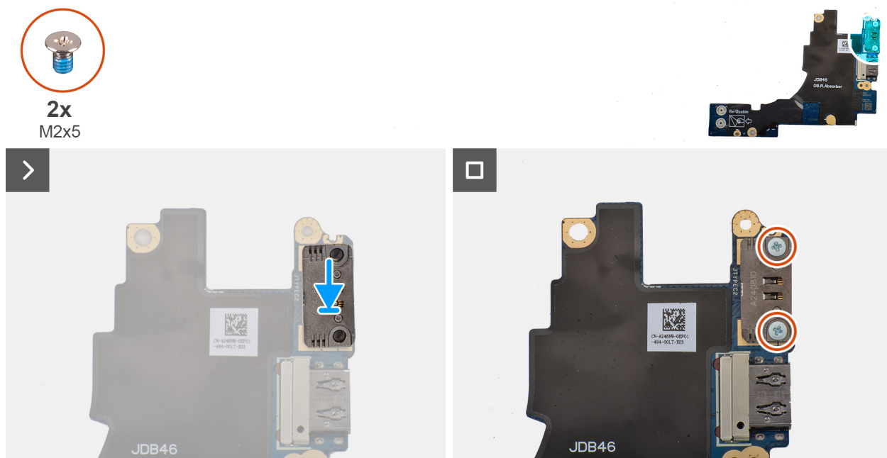
Figure 53. Installation du module USB-C gauche
