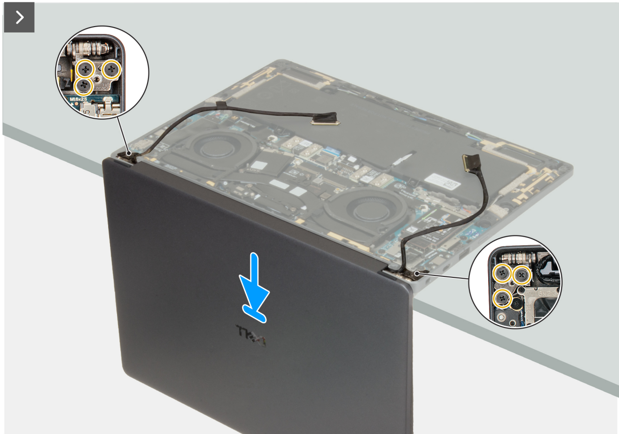
Figure 61. Installation de l'assemblage d'écran
