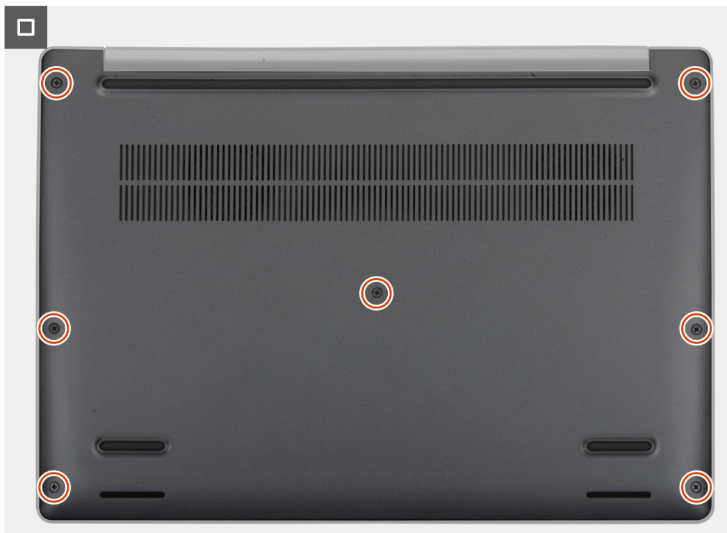
Figure 21. Serrage des vis imperdables
