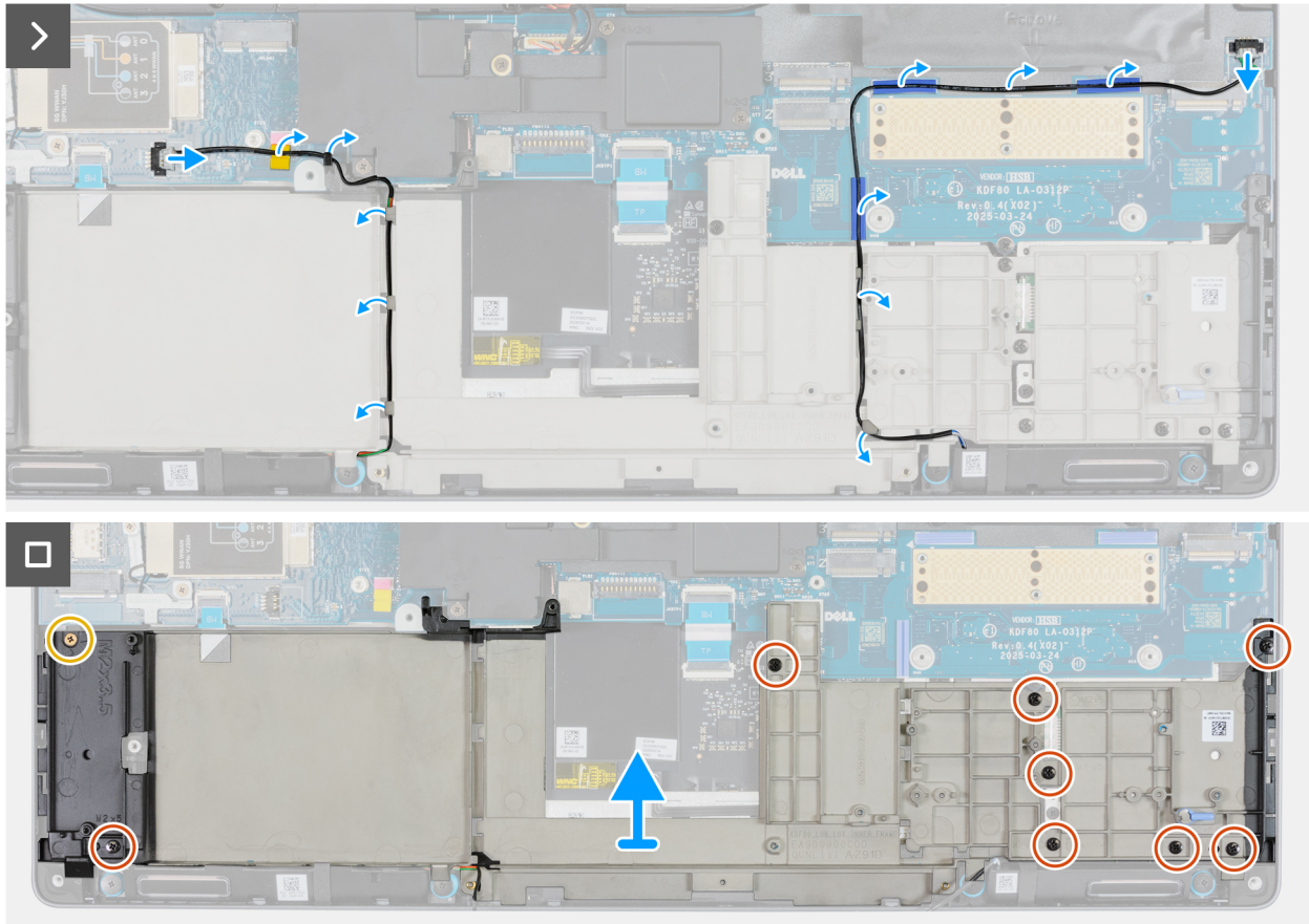
Abbildung 79. Entfernen des inneren Rahmens
