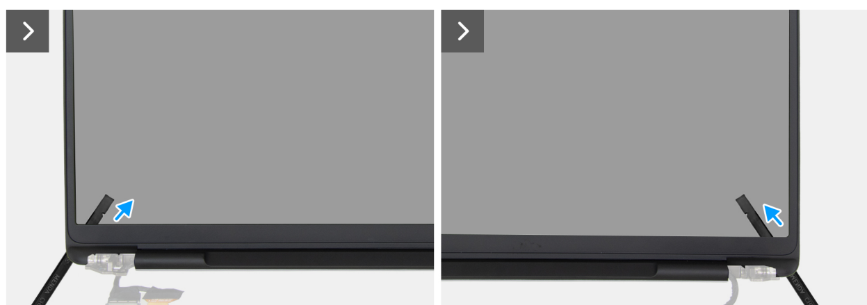
Abbildung 84. Entfernen der Bildschirmblende
