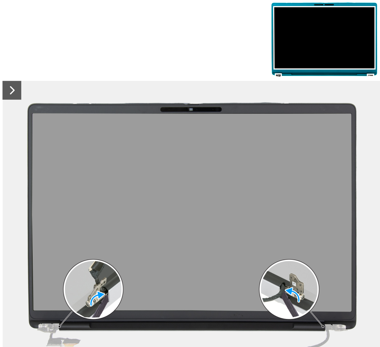
Abbildung 83. Entfernen der Bildschirmblende
