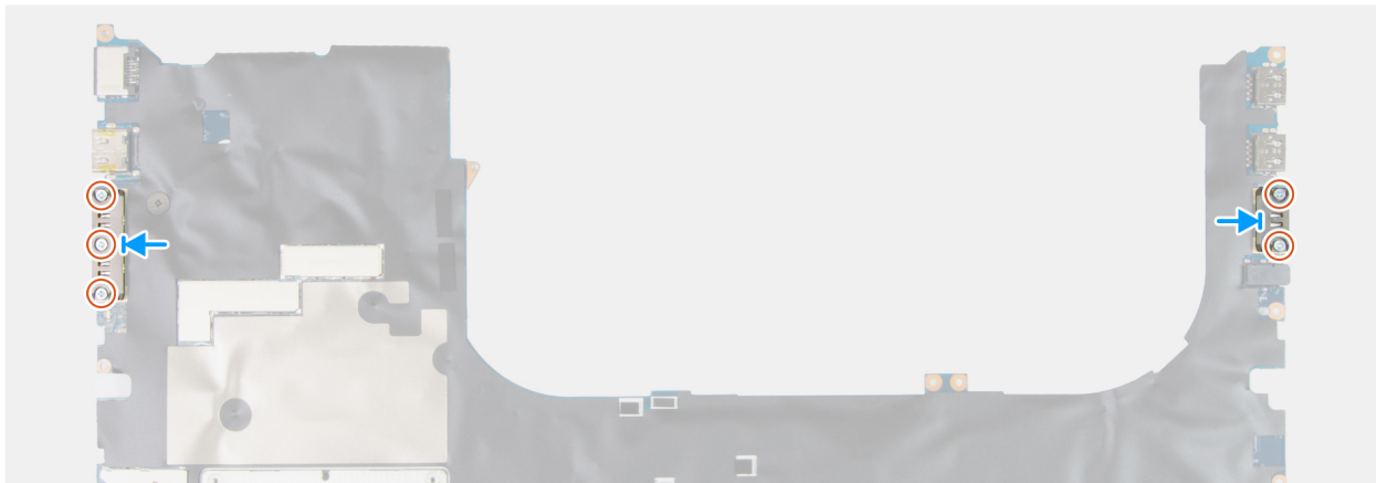
Abbildung 114. Installieren des USB-Typ-C-Anschlussmoduls
