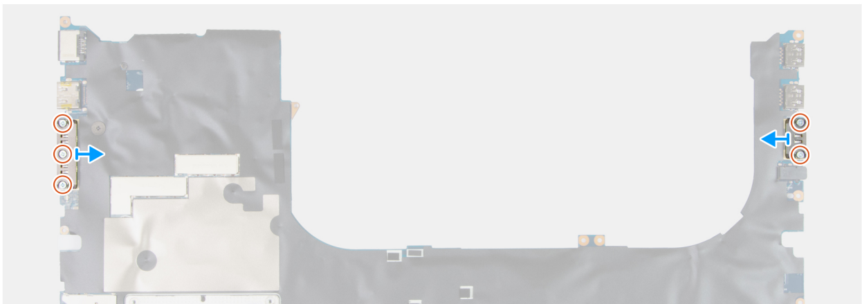
Abbildung 113. Entfernen des USB-Typ-C-Anschlussmoduls
