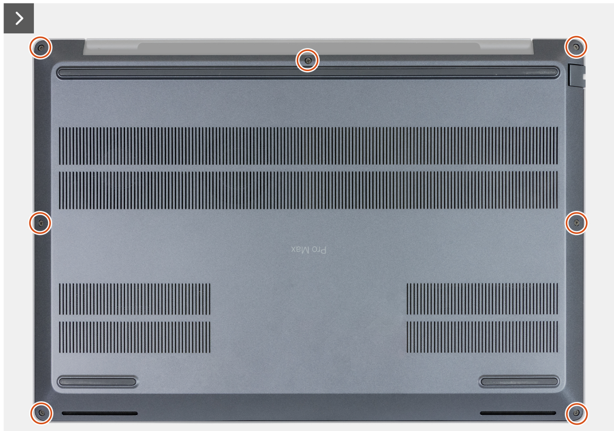
Abbildung 24. Lösen der unverlierbaren Schrauben
