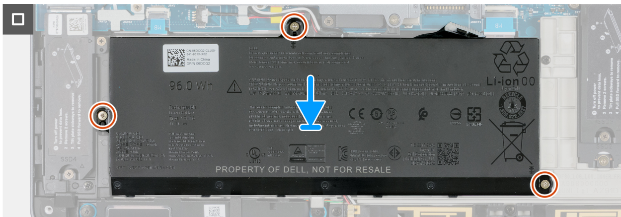
Abbildung 47. Wiedereinbau des Akkus
