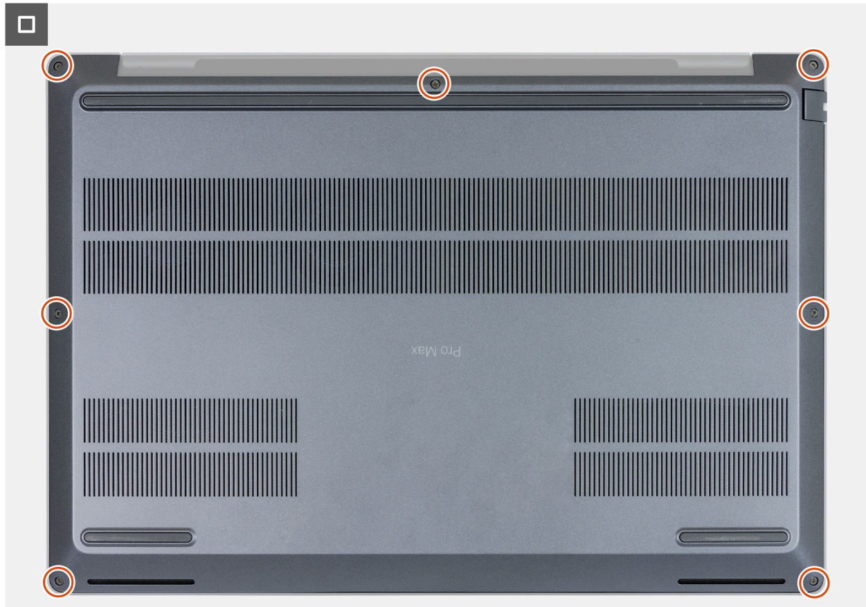
Abbildung 29. Festziehen der unverlierbaren Schrauben
