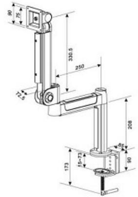
Die NewStar Tischhalterung, das Modell FPMA-D941, ist ein Neig-, Schwenk- und Drehbare Tischhalterung für Flachbildschirme bis 24" (60 cm). Diese Halterung ist eine gute Wahl für platzsparende Platzierung auf Schreibtischen mittels einer Tischklemme.
